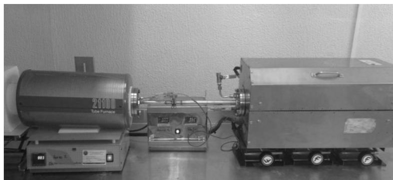
Figura 5.1. Fotografía del equipo para la síntesis de nanopartículas de carbón.
