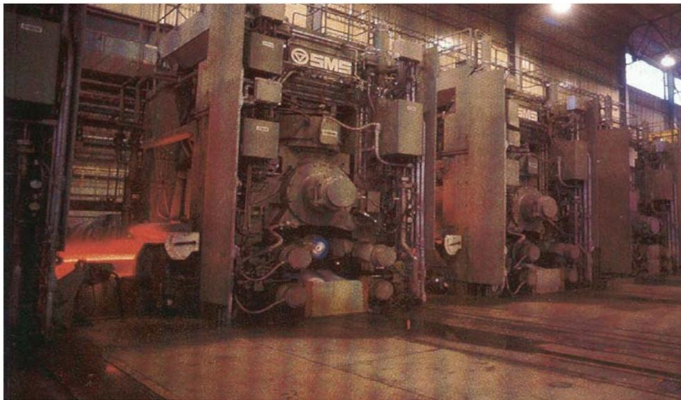
Figura 2.01. Molino de laminación en caliente continuo del tipo cuarto, compuesto por varios castillos de trabajo.
