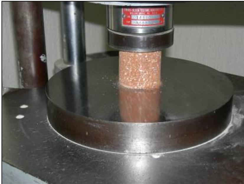
**Figura 3.2** Prueba de resistencia a la compresión.
