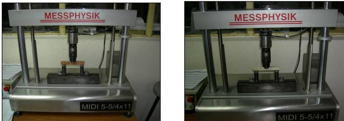
**Figura 3.5** Probeta colocada para la prueba de resistencia a la flexión.
