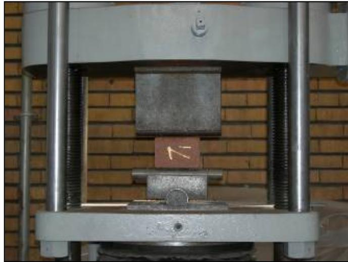
**Figura 3.3** Prueba de modulo de ruptura en frío.
