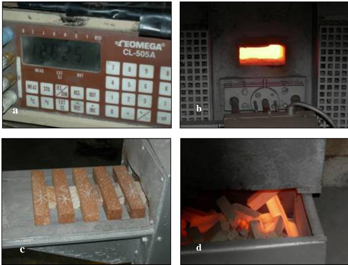
**Figura 3.4** Imágenes de la prueba en secuencia de módulo de ruptura en caliente.
