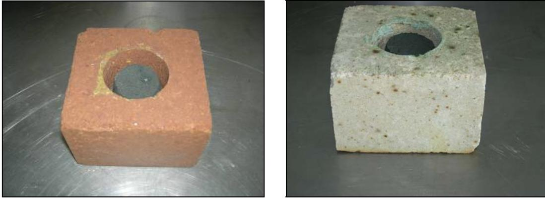
**Figura 3.6** Crisoles retirados del horno después de la prueba realizada con harina en su interior.
