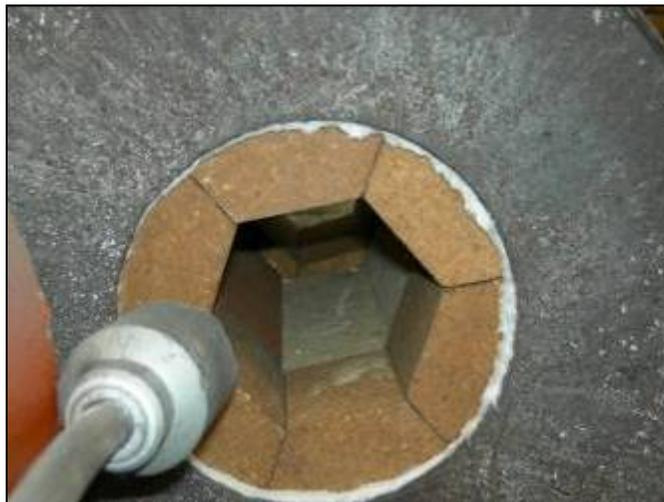
**Figura 3.7** Arreglo de los ladrillos dentro de una coraza cilíndrica para la simulación de un horno rotatorio.
