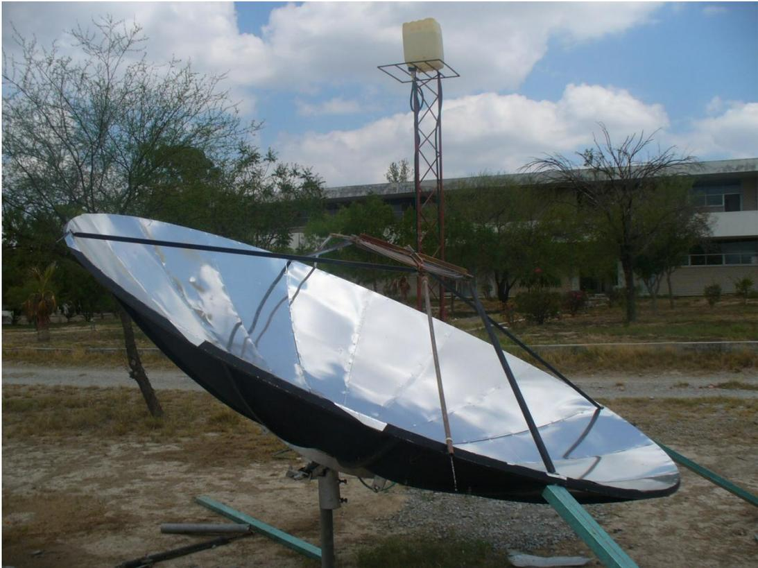
**Figura 9.- Concentrador solar tipo parabólico con flujo por gravedad para la desinfección del agua.**
