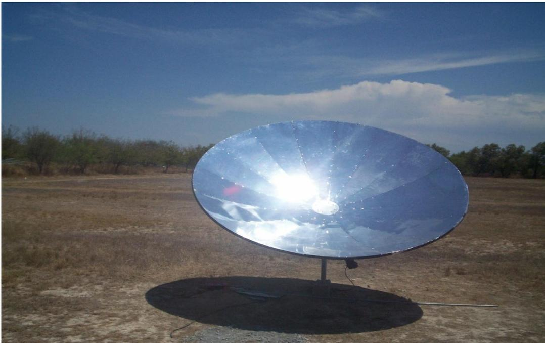
**Figura 7.- Recubrimiento de la parábola con acero inoxidable y papel poliéster.**
