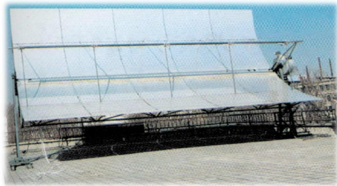
**Figura 4. Concentrador solar cilíndrico, según de Zhifeng *et al.*, 2010.**
