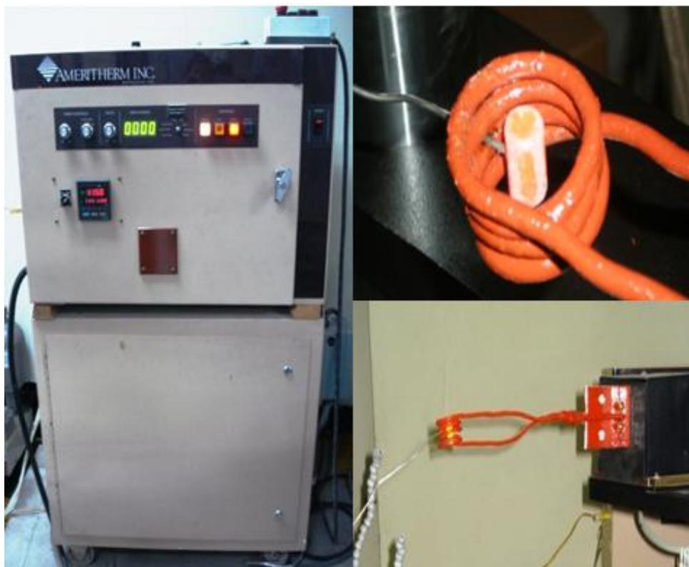
Figura 3.4 Horno de inducción (izquierdo) y bobina del inductor donde se oxidaron las muestras (derecha).
