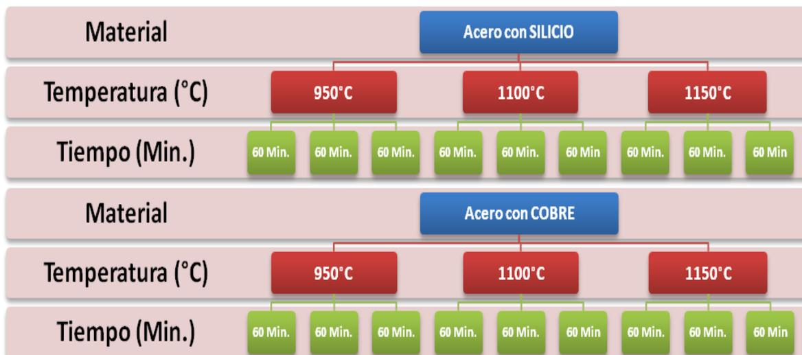
Figura 3.11 Matriz de experimentación para cinética de oxidación a alta temperatura con aire como atmósfera oxidante, en TGA
