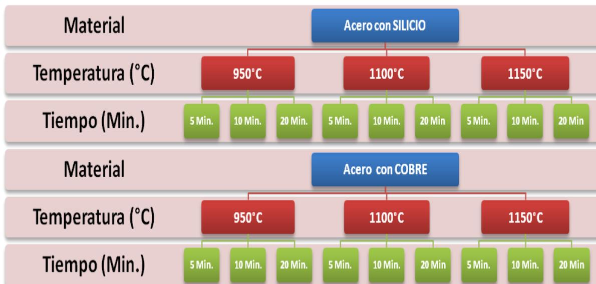
Figura 3.3 Diseño de matriz de experimentos para el estudio de la cinética de oxidación a alta temperatura.
