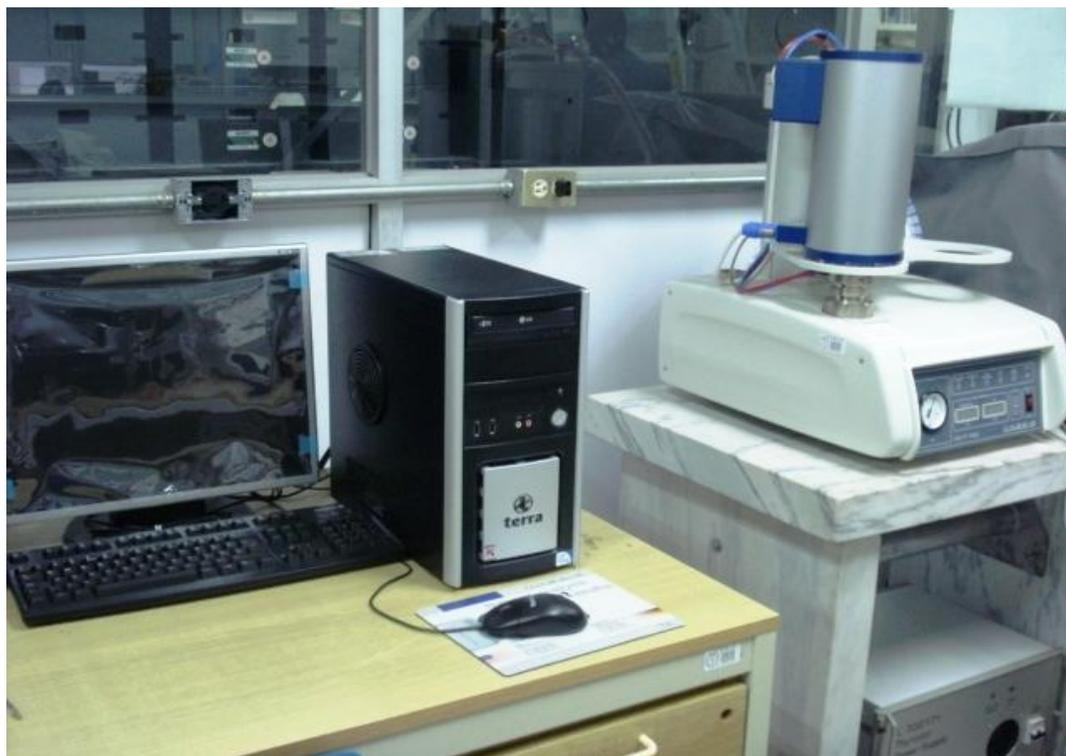
Figura 3.10 Analizador de Termogravimetría (TGA-STA-PT-1600)
