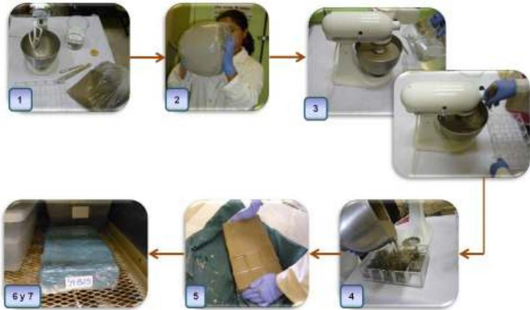
**Figura 11.- Fabricación de las probetas de pasta de cemento; (1) Preparación de los materiales, (2) Homogeneizado, (3) Mezclado, (4) Vaciado, (5) Vibrado, (6 y7) Probetas en condiciones de 100% humedad y temperatura ambiente.**
