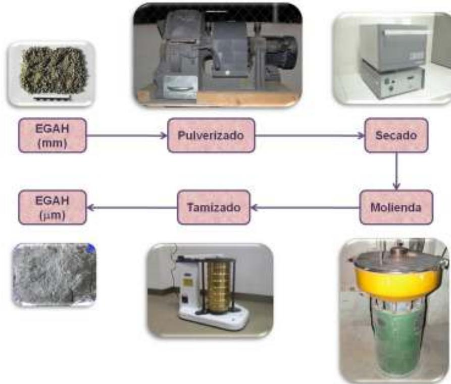
Figura 8.- Procesamiento de la escoria granulada de alto horno.
