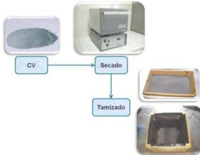
**Figura 9.- Procesamiento de la ceniza volante.**
