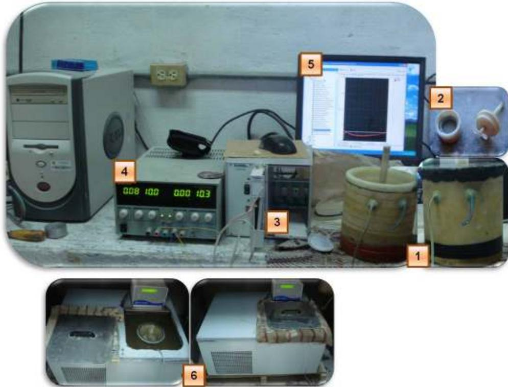
**Figura 13.- Calorímetro Isotérmico; (1) Celdas exteriores, (2) Celda interior, (3) Dispositivo de adquisición de datos , (4) Fuente de poder, (5) Software, (6) Baños a temperatura constante.**
