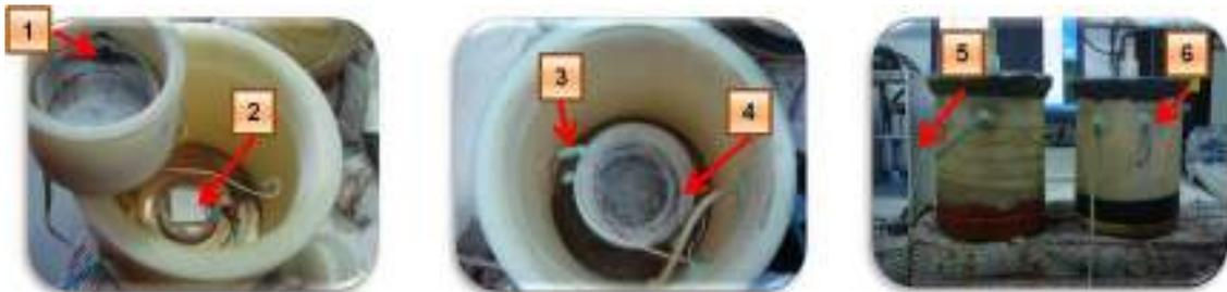
**Figura 14.- Celda exterior e interior; (1) Resistencia – Cobre, (2) Sensor, (3) Cable del sensor, (4 y 5) Cable resistencia - dispositivo adquisición de datos, (6) Manguera de entrada de agua.**
