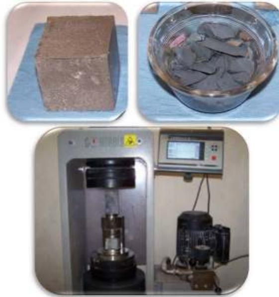
**Figura 12.- Ensayo de resistencia a la compresión en cubos de pasta de cemento.**
