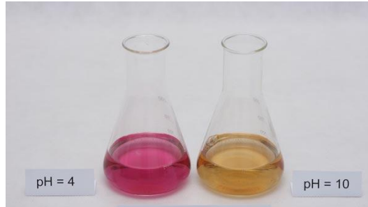
Figura 6. Coloración de la solución de rojo neutro en distintas condiciones de pH.
