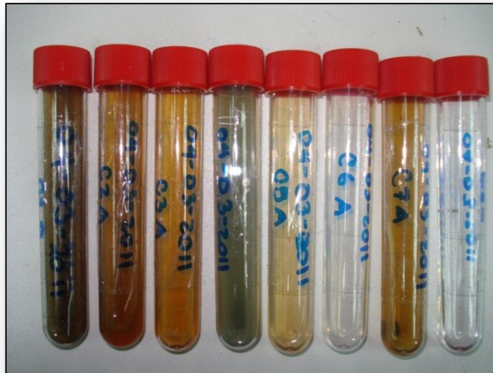
Figura 4.22 Toma de muestra de la solución a cada lado de la celda de migración
