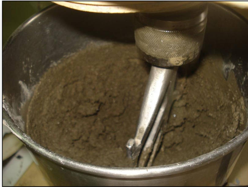
Figura 4.6 Incorporación de la arena normalizada
