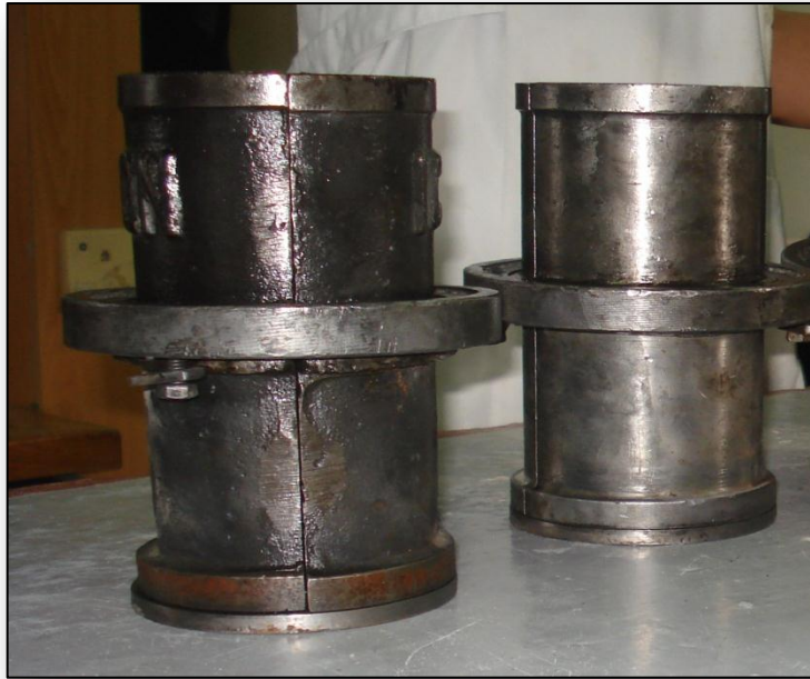
Figura 4.3 Moldes cilíndricos de acero
