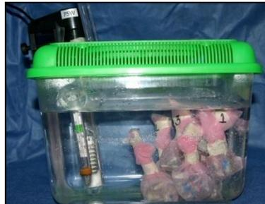
Se procedió a sembrar los premolares en acrílico de fraguado rápido Nic tone mdc (Zapopan Jalisco) en moldes prefabricados de acero inoxidable.
