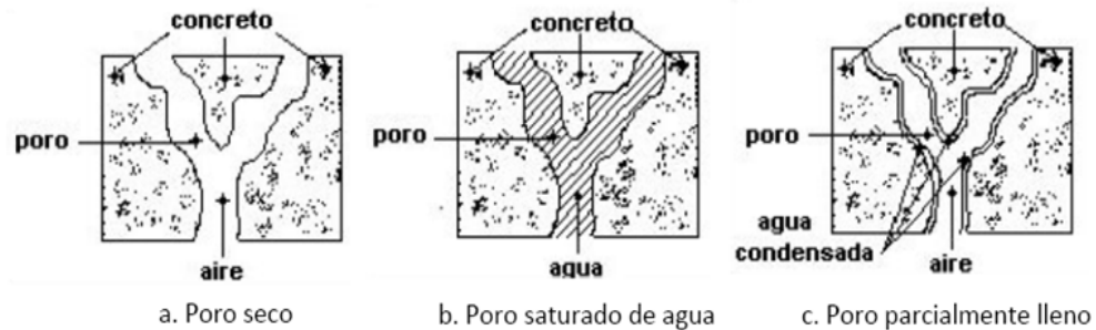
Figura 16. Distintas condiciones de humedad en la matriz de concreto.
