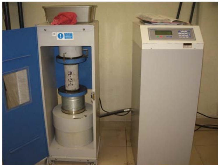
Figura 37. Prueba de resistencia a compresión.
