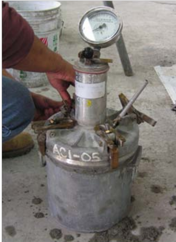
Figura 34. Determinación del contenido de aire por el método de presión.
