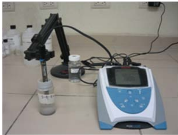
Figura 40. Equipo de medición de pH en muestras de concreto pulverizado.
