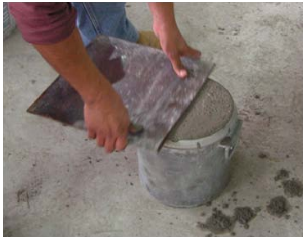
Figura 33. Enrase de la muestra de concreto para la determinación de la masa unitaria.
