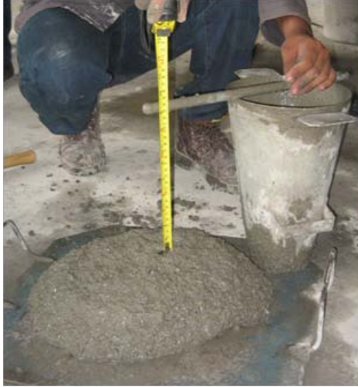
Figura 32. Medición del revenimiento.
