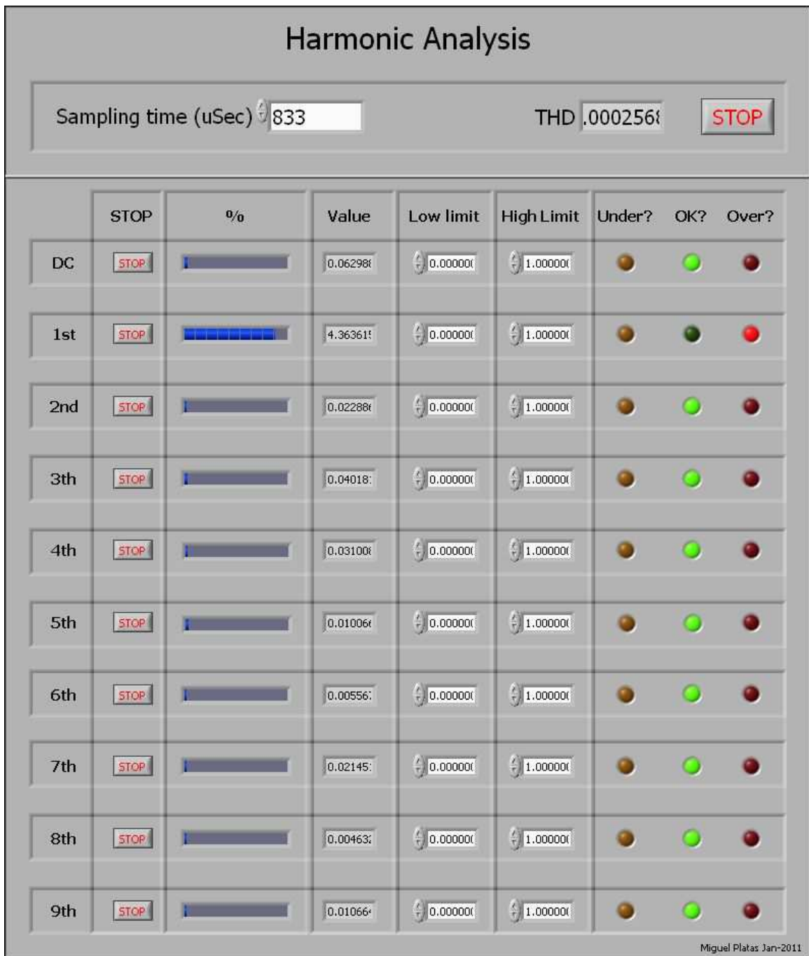
Figura 4.16: Interface de usuario para el chip FPGA, mostrando estimación de una señal sinusoidal de 60 Hz.
