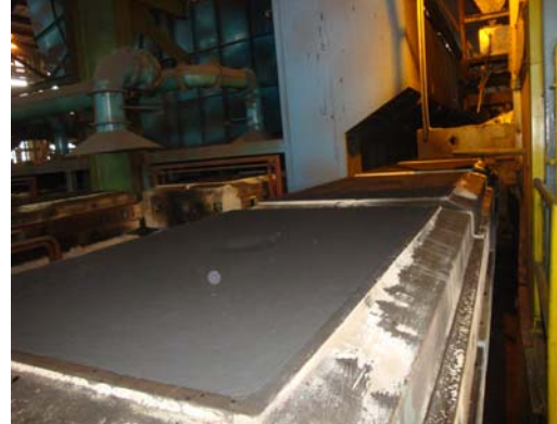
Figura 4.1.7 Adoberas en línea de vaciado.
