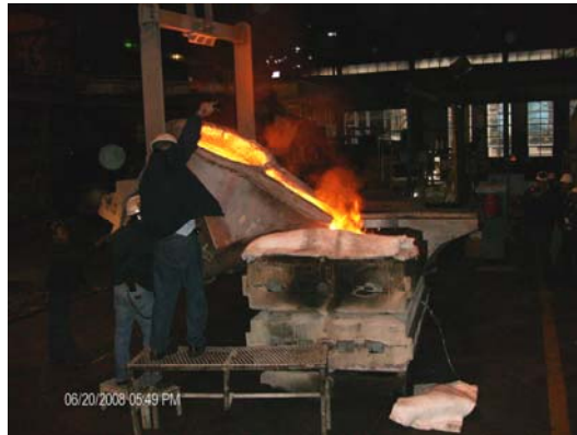
Figura 4.2.3 Vaciado manual de la olla fuera de la línea de producción
