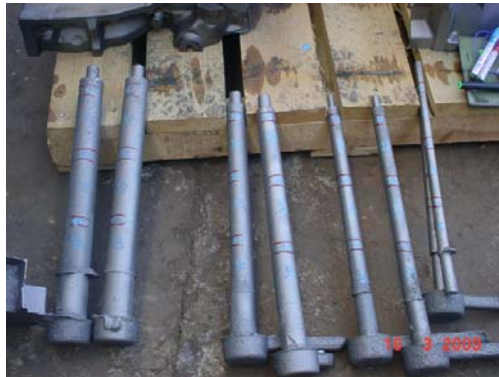
Figura 4.2.4 Barras limpiadas y marcadas para pasar al área de corte.
