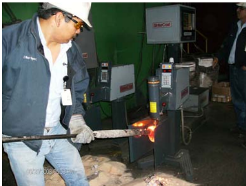
Figura. 4.2.1 Inmersión de la copa de muestreo en el metal pre-tratado
