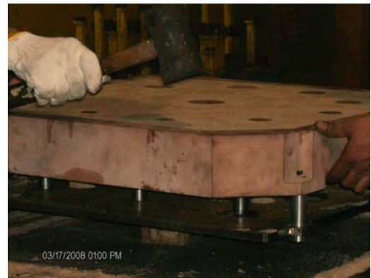
Fig. 4.1.3 Expulsión del corazón mediante la placa de botadores
