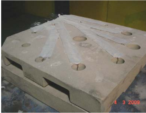
Figura 4.1.4 Corazón de arena con termopares al centro de cada diámetro.
