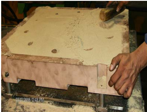
Figura 4.1.2 Apisonamiento de la arena la placa de botadores
