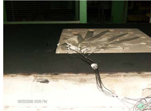
Figura 4.1.5 Corazón con termopares montados sobre el molde inferior de arena en verde.
