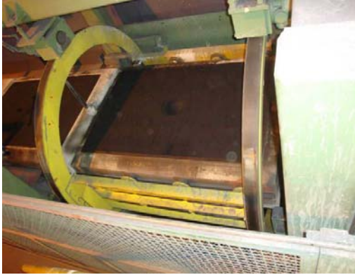
Figura 4.1.6 Molde superior colocado sobre el inferior
