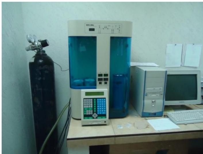
**Figura 4.1** Equipo para análisis BET NOVA 2000e de Quantachrome Instruments.
