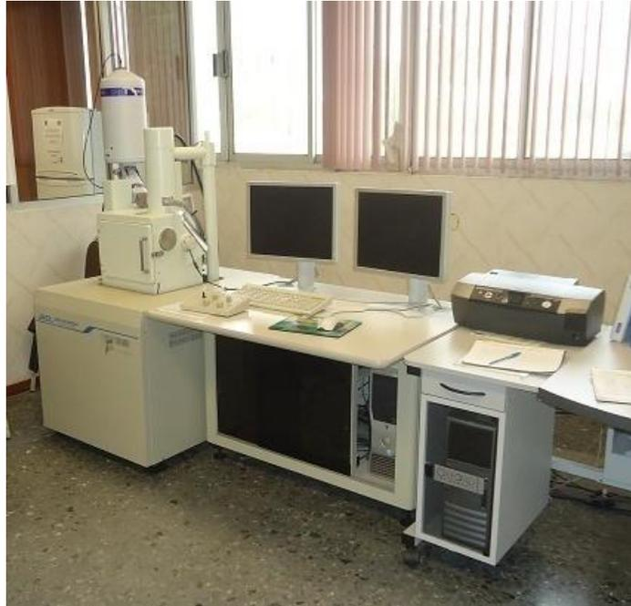
**Figura 4.3** Equipo de Microscopia Electrónica de Barrido (MEB) JSM-6490LV de JEOL.
