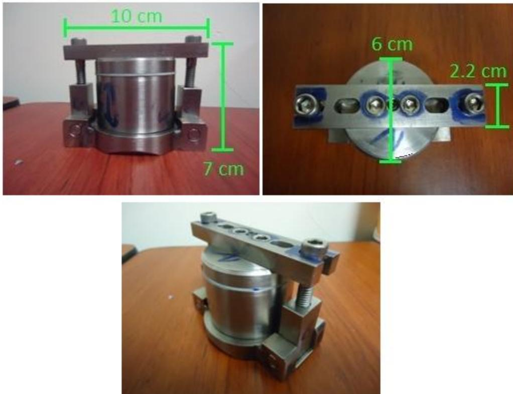
**Figura 2.2** Diseño de tazón de acero inoxidable para la fabricación de aleaciones bajo atmosfera controlada.
