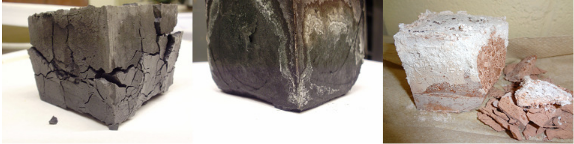
Figura 31: Daño por c/d tras 6 ciclos en contacto con agua (izq la CV, al centro la E y der el metacaolín).
