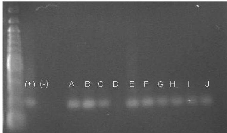
**Figura 13. Fotografía de gel de agarosa teñido con bromuro de etidio, mostrando uno de los resultados de PCR anidado usando los primers 17kDa. Usado como tamiz para posteriormente realizar un intento de aislamiento en cultivo celular y caracterización de los positivos.**
