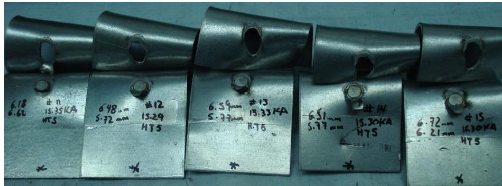
a) Corriente de soldadura de 15.5 KA con un tiempo de mantenimiento de 5 ciclos
