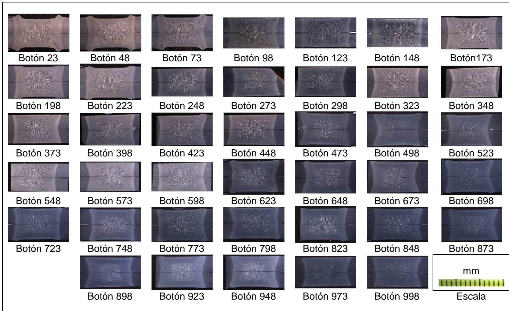
Figura 5.49 - Macrografías de la sección transversal de los botones de soldadura del acero HSLA 3.09 mm
