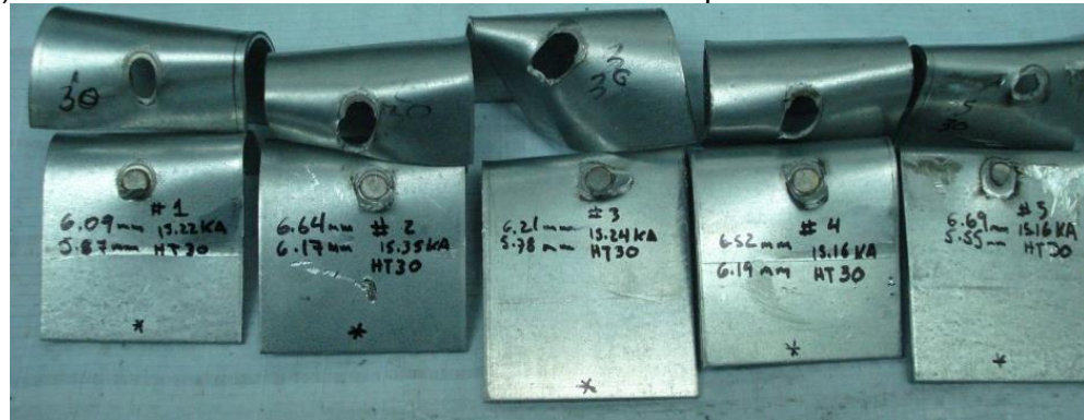
b) Corriente de soldadura de 15.5 KA con un tiempo de mantenimiento de 30 ciclos
