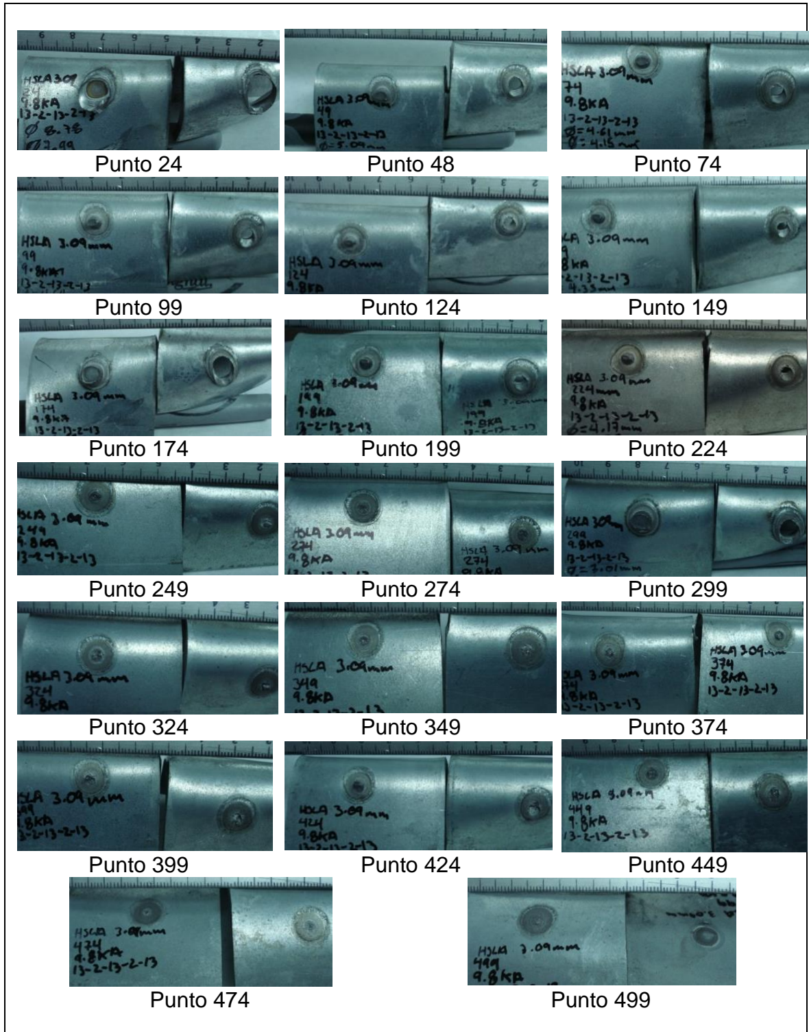
Figura 5.52 - Ensayos de desbotonamiento de la corrida de 1 a 499 puntos soldados en el acero HSLA 3.09 mm.
