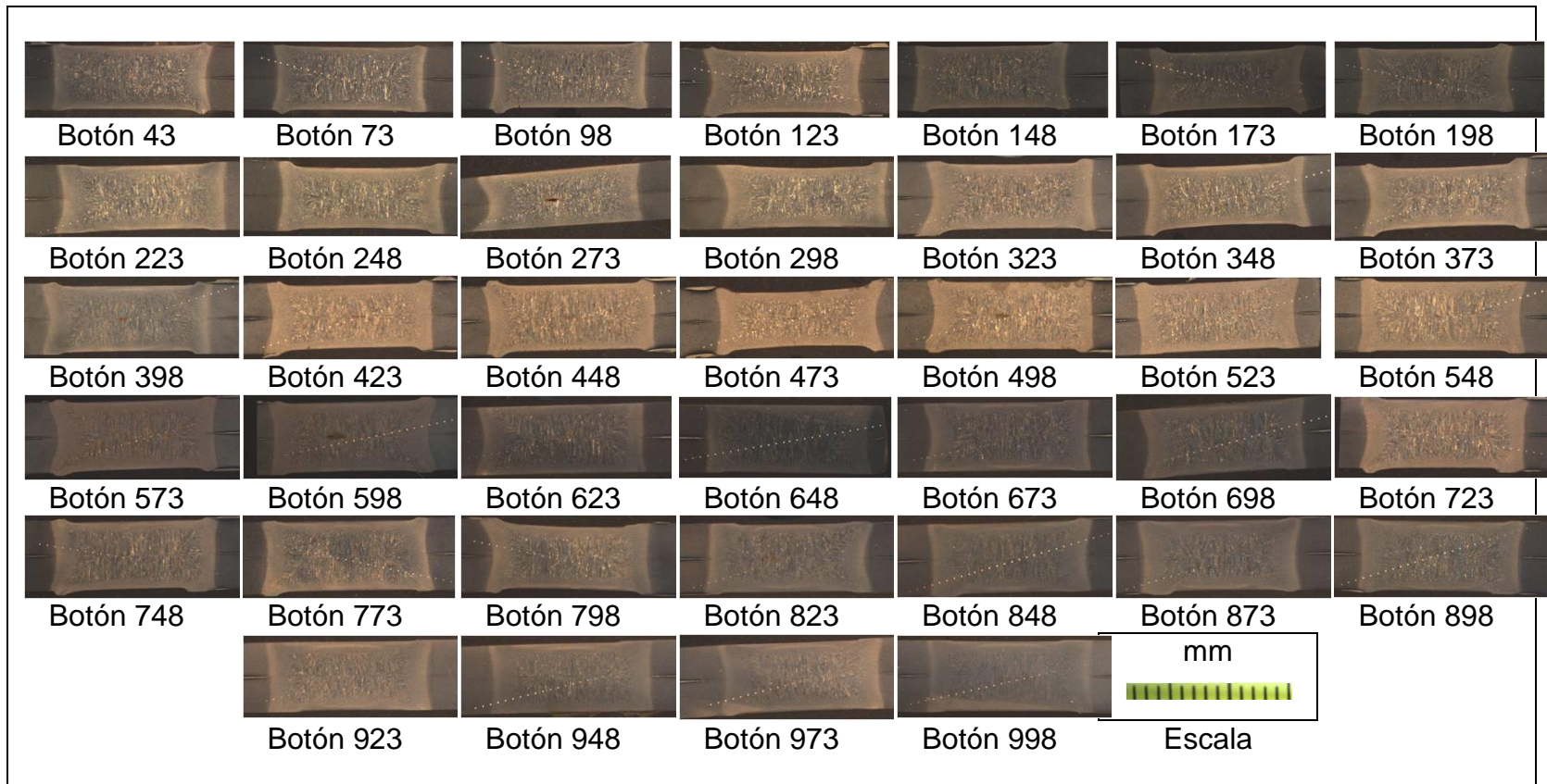
Figura 5.47 - Macrografías de la sección transversal de los botones de soldadura del acero HSLA 1.81 mm
