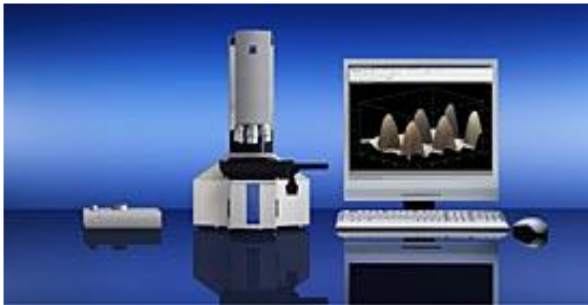
Figura 4.11. Microscopio confocal ZEISS Mod. Axio CSM 700 para medir la rugosidad 3D.
