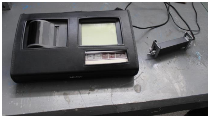
Figura 4.10. Rugosímetro Mitutoyo Modelo SJ 301 para medición del Inconel 617 e Inconel 718.
