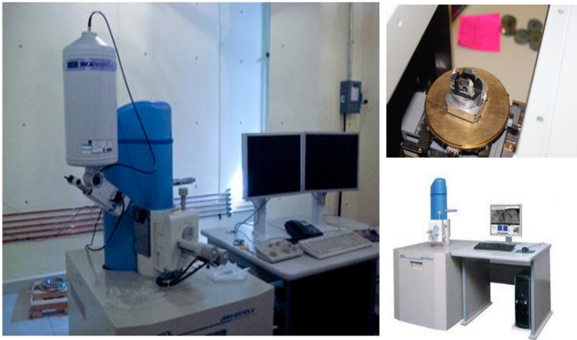
Figura 4.14. Microscopio Electrónico de Barrido JEOL Modelo JSM-6510LV y muestras de herramientas de CBN listas para ser observadas.
