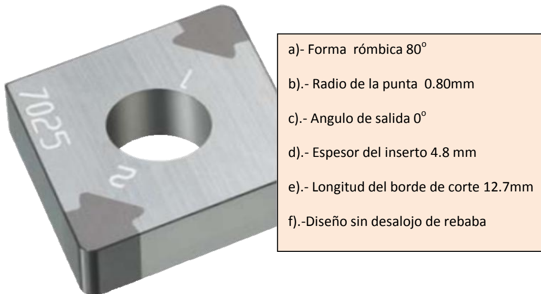
Figura 4.3. Herramienta de CBN y sus características [13].
