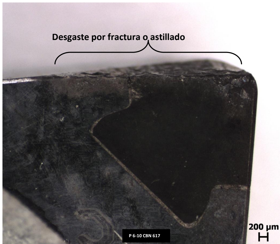
Figura 5.44. Mecanismos de desgaste de la herramienta de CBN utilizada para maquinar Inconel 617 a V_c de 100 a 180 m/min, se observa principalmente desgaste por astillamiento.
