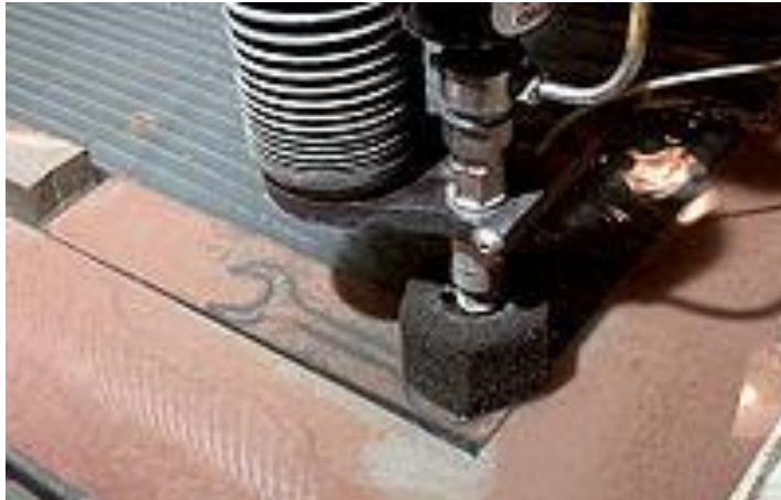
Figura 2.9. Un cortador abrasivo por chorro de agua acaba una herramienta especial [16].
