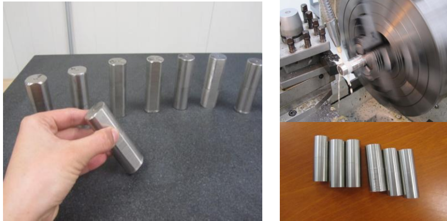
Figura 4.5. Superaleación 617 donado por la empresa FRISA Aerospace.
