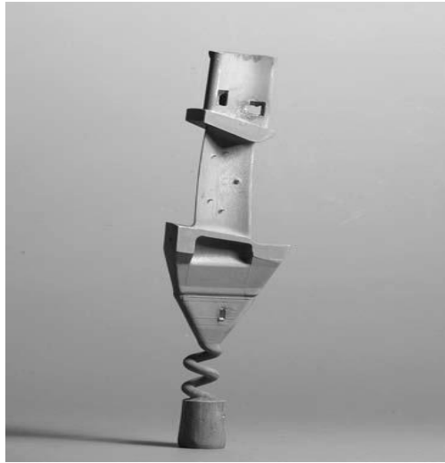
Figura 3.5. Ábabe de fundición de turbina de alta presión del motor Rolls-Royce Trent 800, después de la eliminación de la cáscara de inversión. Muestra además los detalles del bloque de arranque y selector del grano de cola de cerdo [6].
