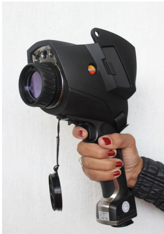
Figura 4.8. Imagen de la cámara Termográfica Testo 881.
