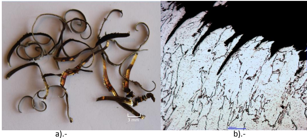
Figura 5.32. Rebaba de probetas de Inconel 617 maquinadas a V_c=100 y 120 m/min con herramienta de CBN del tipo cinta corta y en arco, b).- Microestructura de la Rababa de la probeta maquinada a 120 m/min.
