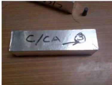
**Figura 16.** Probeta recubierta con aluminio.
