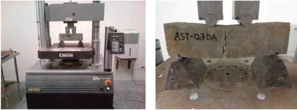
**Figura 13.** Ensayo de resistencia a la flexión según la norma ASTM C-78.
