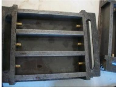
**Figura 15.** Molde para especímenes de contracción.
