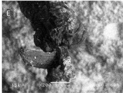
**Figura 42.** MEB (LV-BSE) de la sección de ruptura de compuesto reforzado con fibras de agave en una matriz base cemento expuestas a un deterioro acelerado. (a: x50; b: x450; c: x50; d: x400; e: x200).
