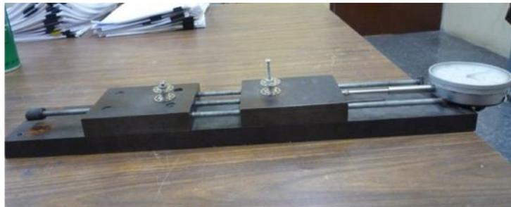
**Figura 5.** Equipo para ensaye a tensión de la fibra.
