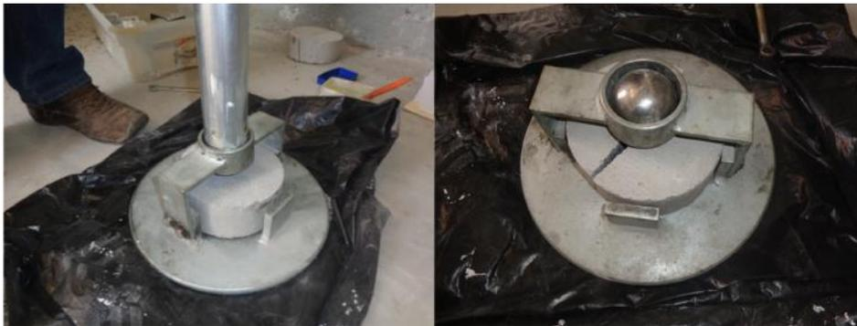
**Figura 14.** Ensaye de Resistencia al Impacto.
