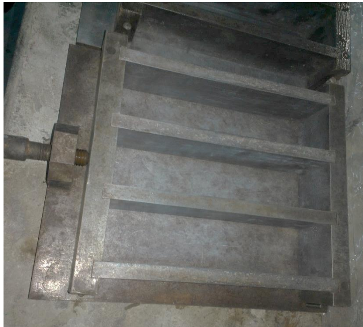
Figura 3.5 Moldes empleados para la fabricación de las probetas para ensayos de flexión y compresión.
