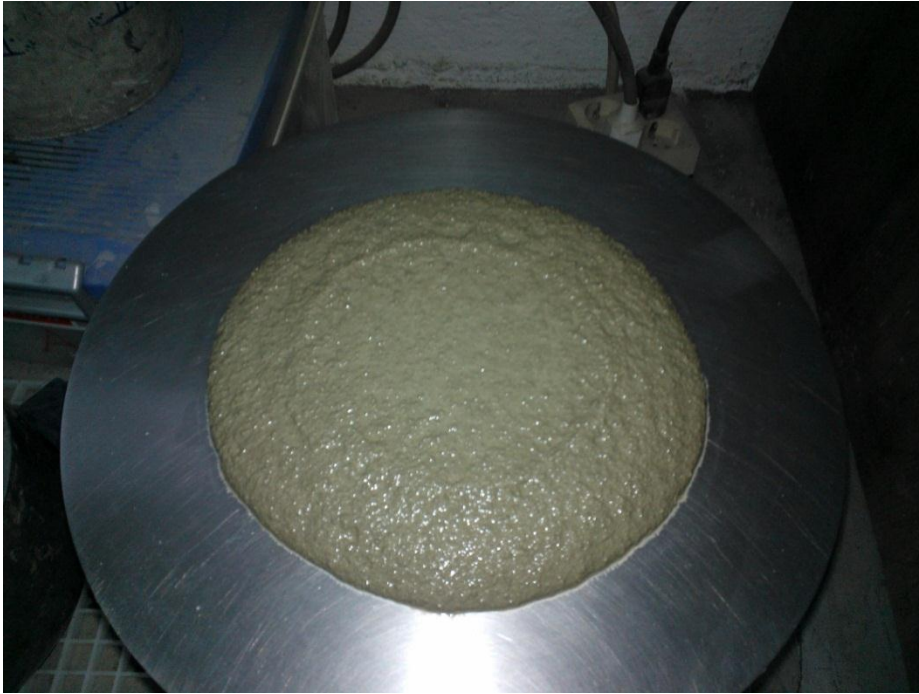
Figura A-I.1 Prueba de consistencia de un mortero fresco realizada sobre la mesa de sacudidas.
