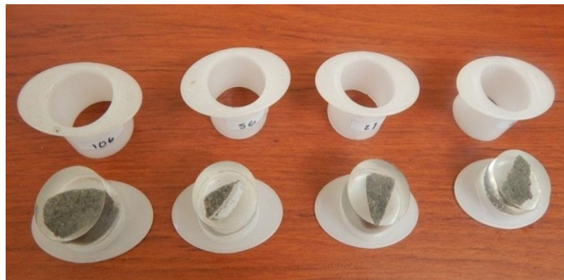
Figura 3.9. Piezas encapsuladas en resina antes de ser pulidas.
