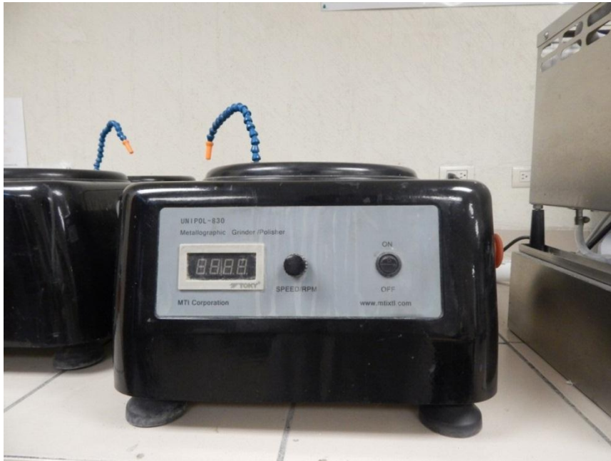
Figura 3.10 Pulidora para metalografías.
