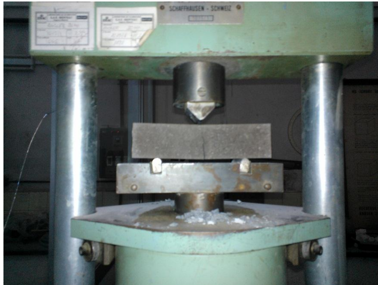
Figura 3.6 Ensayo de resistencia a la flexión.
