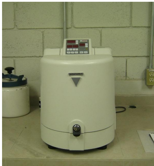
Figura 3.2 Molino planetario usado en el primer proceso de molienda.
