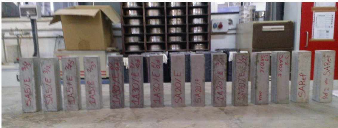
Figura A-II.1 Probetas prismáticas para ensayos a flexión.
