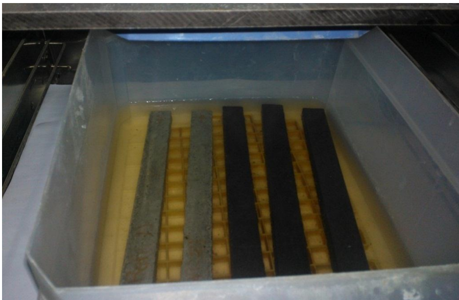
Figura 3.8. Probetas expuestas a tratamiento alcalino.
