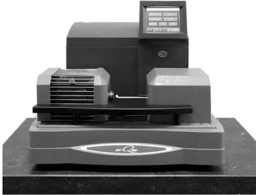
**Figura 25.** Equipo TG-DSC-DTA modelo SDT Q600 utilizado para el análisis térmico de las muestras experimentales del presente trabajo.
