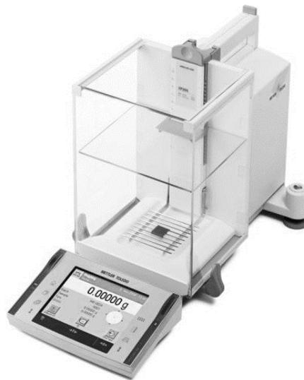
**Figura 18.** Balanza analítica de 5 dígitos utilizada en el presente trabajo.
