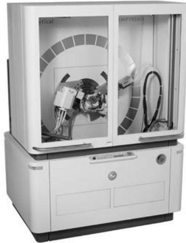
**Figura 23.** Difractómetro de rayos-X Empyrean utilizado para analizar las muestras del presente trabajo.
