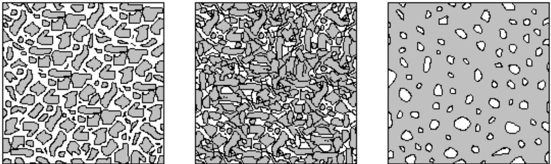
Figura 4 Secuencia del ligamento entre partículas durante la cocción
