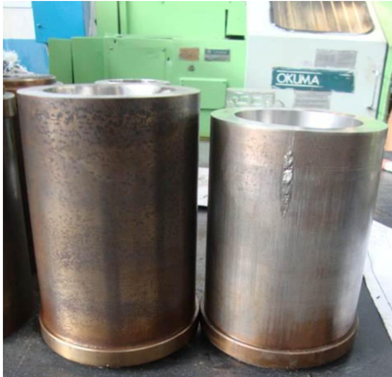
Figura 1.4 Diferencia entre molde nuevo (izquierdo) y Moldes recorrido en dimensiones (derecho)
