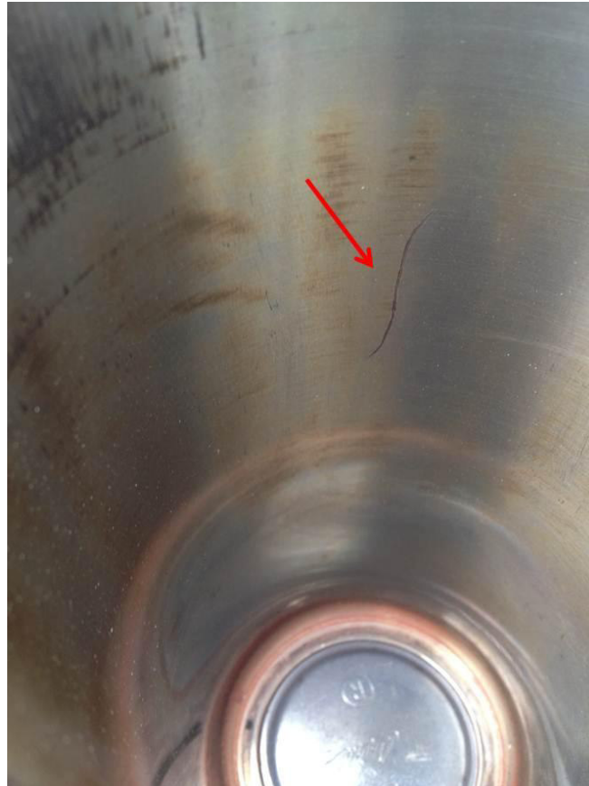
Figura 5.2 Molde con grieta en superficie de trabajo
