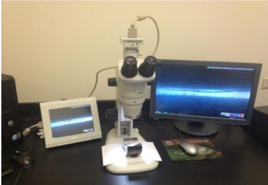
Figura 4.3 Estereoscopio Nikon SMZ 745T
