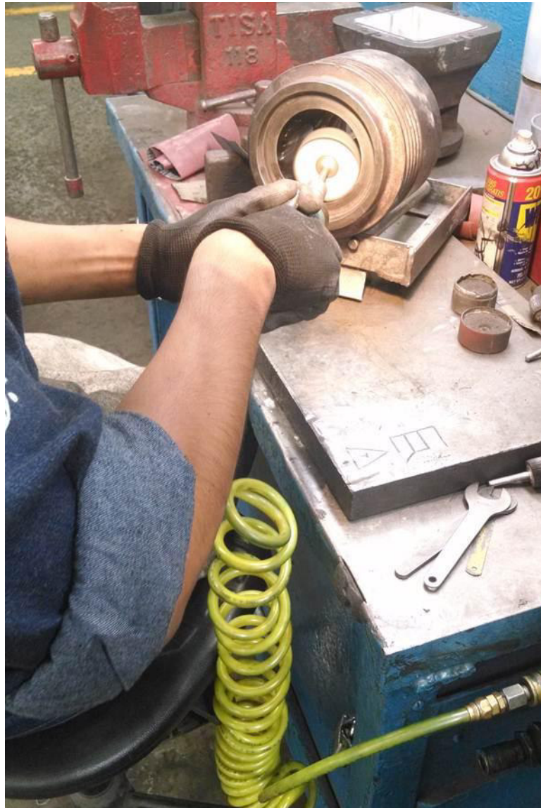
Figura 1.7 Pulido de superficie de moldes
