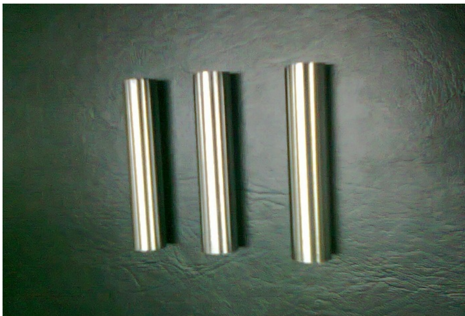
Figura 5.3: Fotografía de probetas maquinadas.
