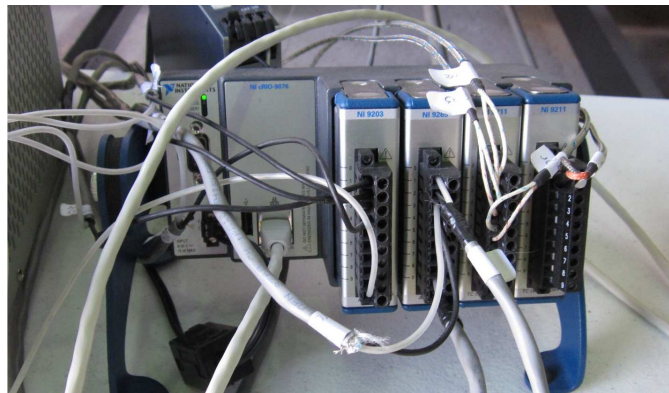
Figura 2.16: Controlador de automatización programable NI CompactRIO.
