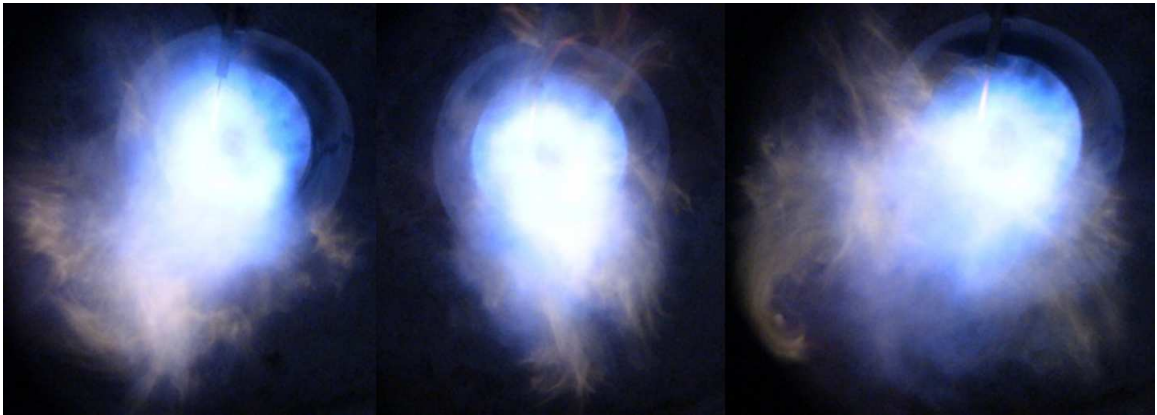
Figura 3.30: Serie de imágenes de la flama al 40 % de la capacidad del quemador.
