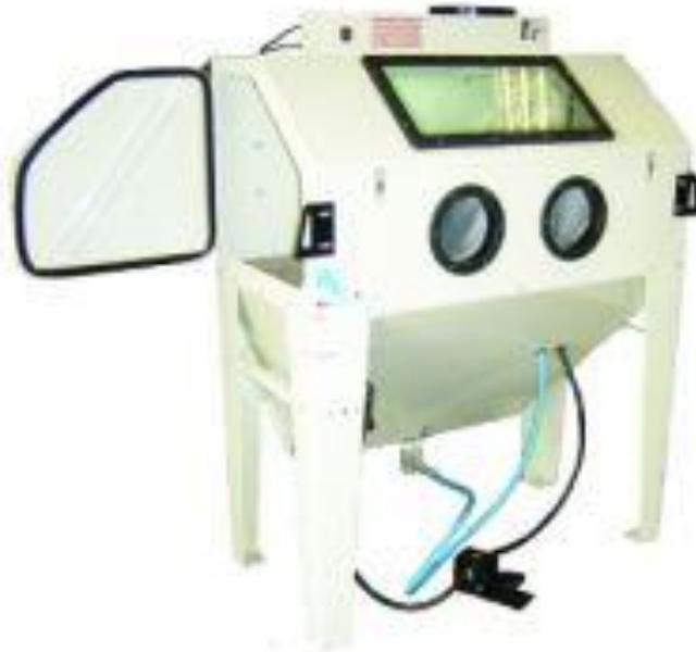
Figura 3.3 CS48 Sandblast Cabinet. Equipo utilizado para la generación de superficie satinada en la probeta.  $Ra=0.397\mu m$ .
