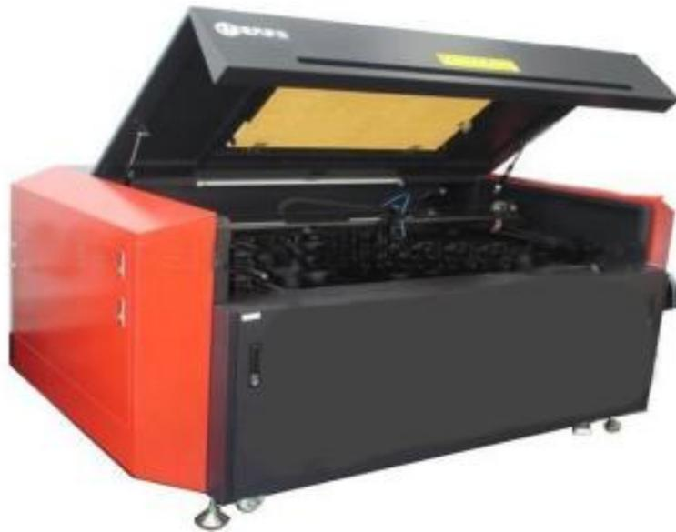
Figura 3.6. Máquina láser CO<sub>2</sub> utilizada para la sinterización de los recubrimientos.
