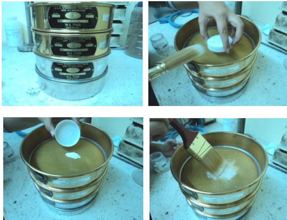
Figura 3.4 Test de malla de Wollastonita y TCP
