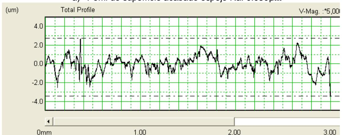
b) Superficie sandblasteada Ra:0.397 $\mu$ m
