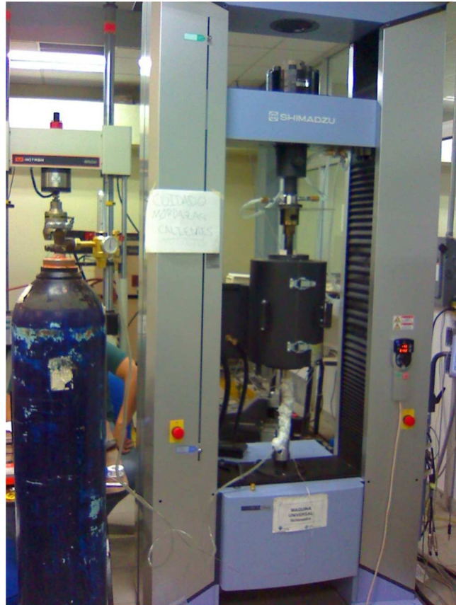
Figura 2. 7 Se observa el equipo ya montado y listo para ensayar las probetas. Obsérvese que el horno tubular rodea al centro de las mordazas en donde se encuentra el espécimen.
