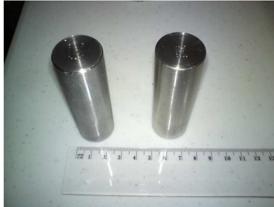
Figura 2. 1 Material recibido en forma de cilindros de 1" de diámetro y 3" de largo, maquinadas de "billets" de aleación 17-4PH que se usa en la industria para la forja y rolado de anillos.
