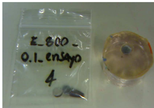
Figura 2. 13 Se observa un extremo de probeta montado en resina y sus correspondientes secciones ya cortadas.
