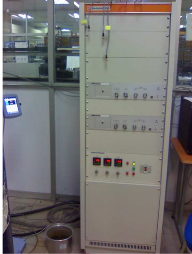
Figura 2. 9 Tablero de control de los extensómetros (no utilizados en este ensayo) y del horno de la máquina Shimadzu.
