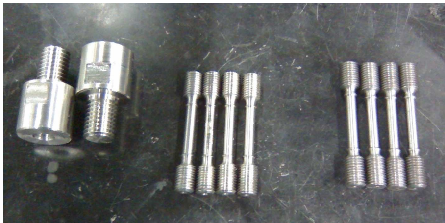
Figura 2. 6 Se observan los dados adaptadores y ocho probetas maquinadas en su inspección de geometrías y tolerancias.
