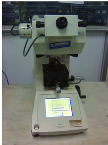
Figura 2. 2 Microdurómetro HMV2 Shimadzu en donde se realizaron las mediciones de Microdureza Vickers.
