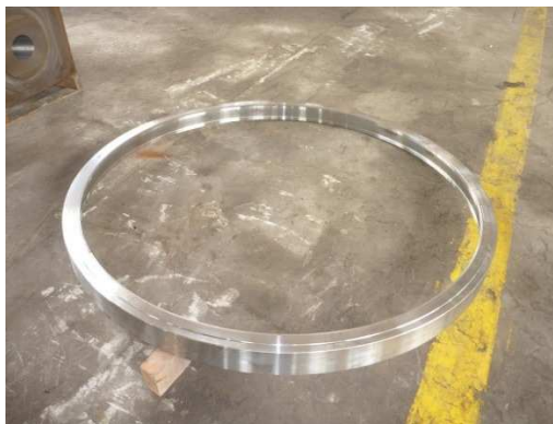
Figura 1. 4 Se observa en la figura, un anillo forjado de aleación 17-4 PH para turbinas de gas para generación de energía eléctrica (10) .
