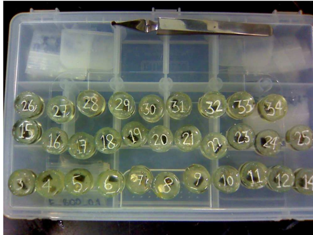
Figura 2. 20 Se muestran los especímenes ya montados en resina y grabados en su parte anterior.
