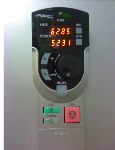
Figura 2. 8 Display lateral de la máquina universal servo mecánica. En este se pueden manipular manualmente el cabezal, fijar los puntos neutros de la celda de carga (poner a cero) y la posición.
