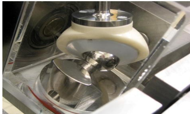
Figura 2.10 Simuladores de cadera: a) simulador de cadera HUT-4 con 12 estaciones de prueba , b) estación de prueba del simulador de cadera HUT-4 mostrando un par tribológico metal-UHMWPE, c) simulador de cadera Shore Western y d) simulador de cadera AMTI [8].
