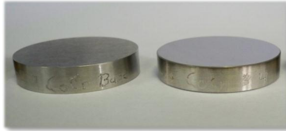
Figura. 3.5. Discos para pruebas tribológicas.
