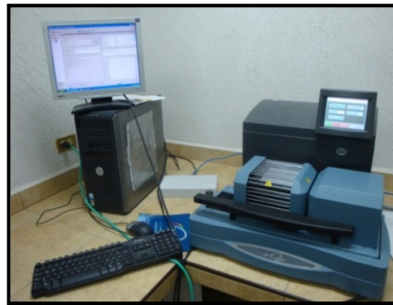
Figura 33. Equipo SDT-Q600-TA para TGA-DTA.
