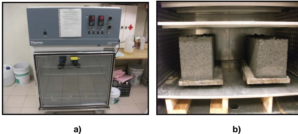
Figura 24. Equipo y periodo de curado. a) Cámara ambiental, b) Bloques de concreto curados.
