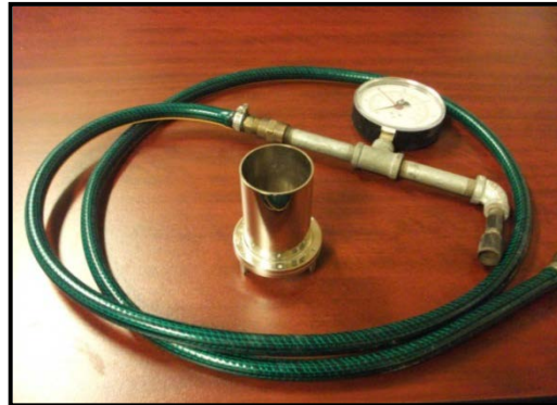
Figura 17. Equipo para determinar la fineza por la malla 325.
