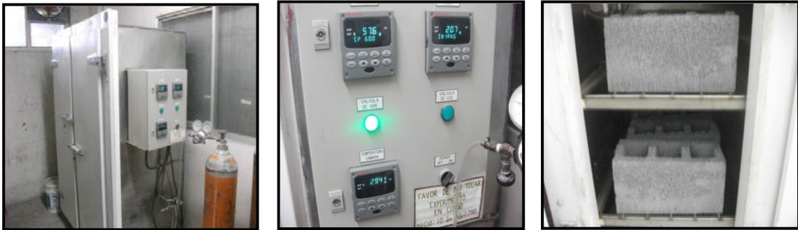
Figura 31. Curado con CO 2 . a) Cámara de carbonatación, b) Panel de control para regulación de humedad relativa, temperatura y concentración de CO 2 , b) Bloques de concreto antes de la carbonatación.
