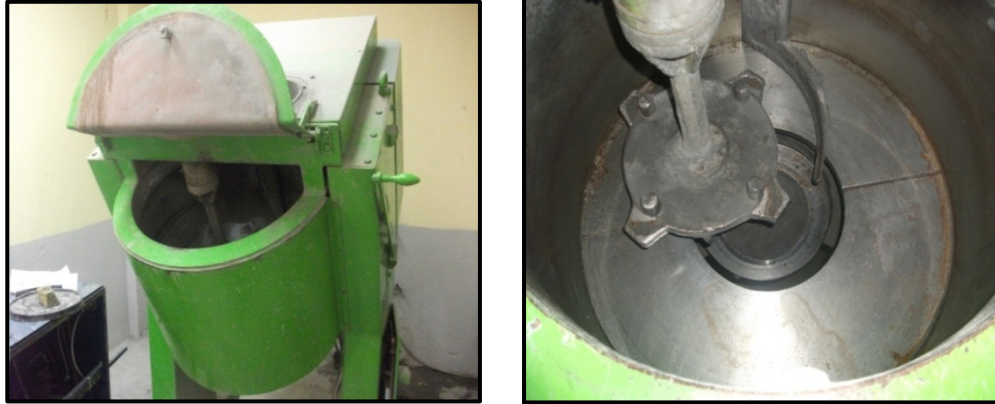
Figura 20. Mezcladora marca Eirich, utilizada en la producción de los morteros.
