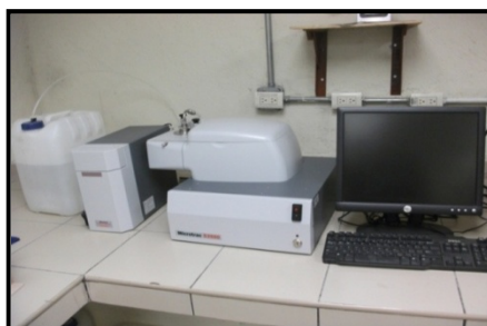
Figura 16. Equipo Microtrac S3500 para obtener la distribución de tamaño de las partículas.
