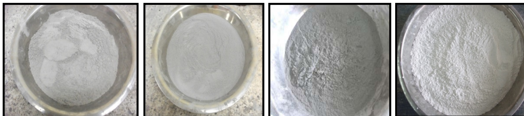
Figura 13. Materiales cementantes. De izquierda a derecha, cemento portland ordinario, ceniza volante, ceniza volante tamizada e hidróxido de calcio.
