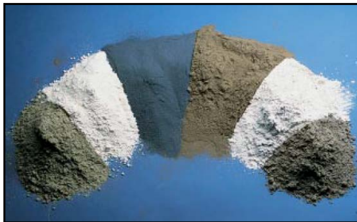
Figura 5. Materiales puzolánicos. De la izquierda a la derecha: ceniza volante (clase C), metacaolín (arcilla calcinada), humo de sílice, ceniza volante (clase F), escoria y esquisto [22].
