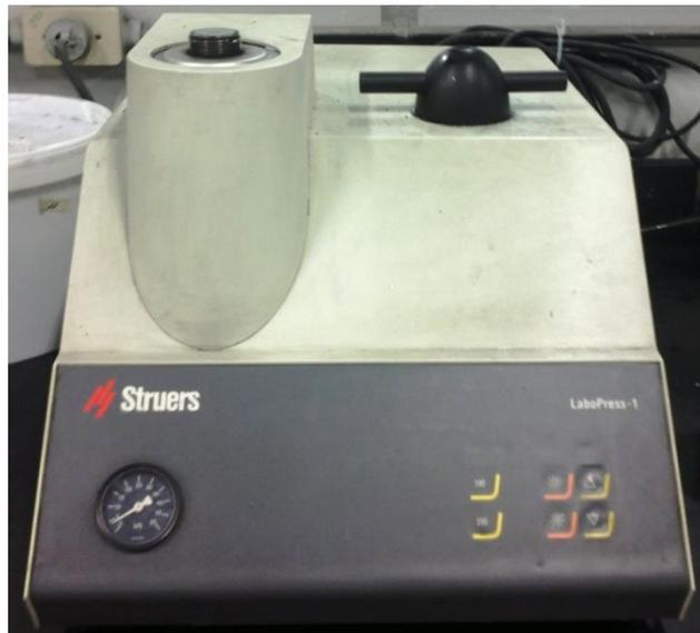
Figura 3.9 Montadora Struers LaboPress-1.
