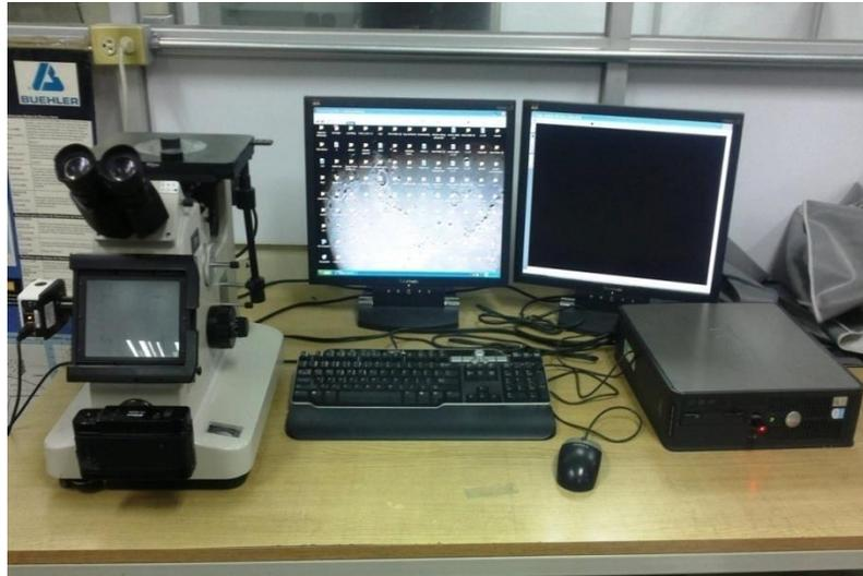
Figura 3.11 Microscopio Óptico Nikon Epihot.
