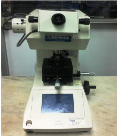
Figura 3.13 Microdurómetro Shimadzu.
