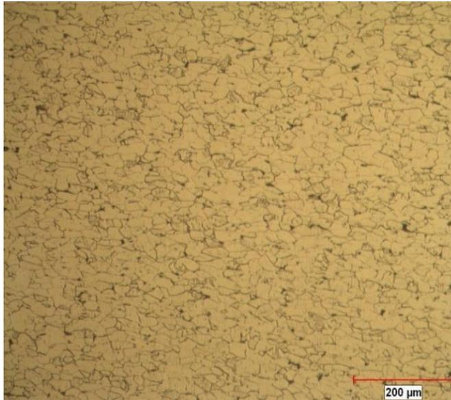
Figura 4.12 Microestructura de acero 1004 después de trefilado.
