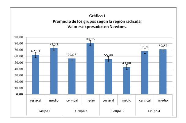
La fuerza de compresión necesaria para de-cementar un poste de fibra de vidrio cementado con resina dual en una pieza obturada con cemento libre de eugenol en su tercio **cervical** es de  $62.13\pm61.19$ nw (IC<sub>95%</sub>= 18.36-105.91 nw) y en su tercio **medio** presento un valor de $72.91\pm41.90$  nw (IC<sub>95%</sub>= 42.93-102.89 nw)
