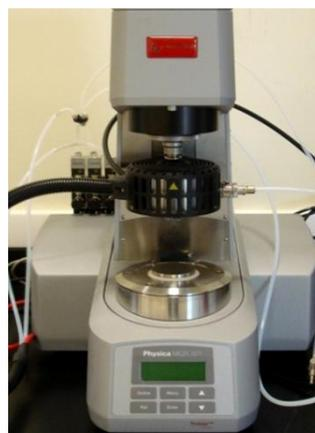
Figura 4.3. Geometría de platos paralelos empleada en el reómetro MCR301.
