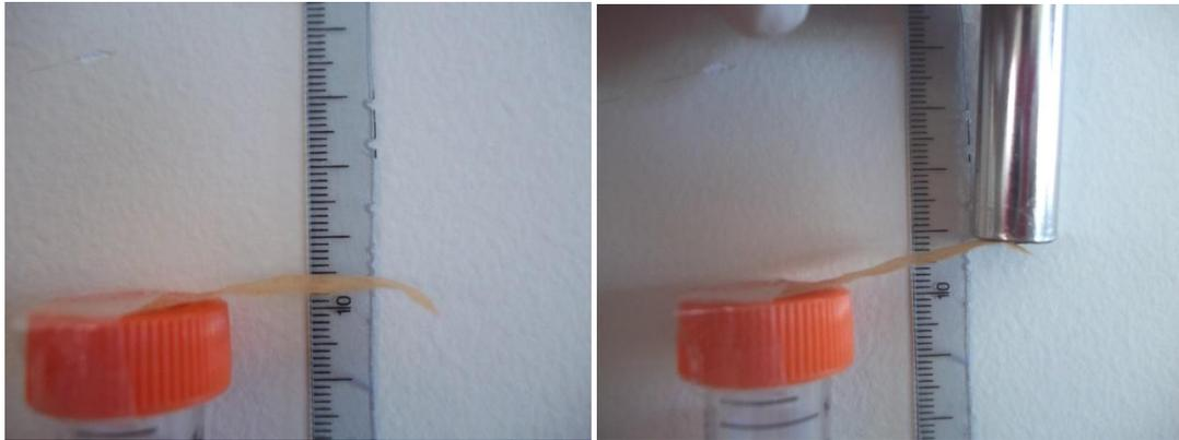
Figura 5.20. Fotografías mostrando la deformación de la película de material híbrido sin y con aplicación de campo magnético externo.
