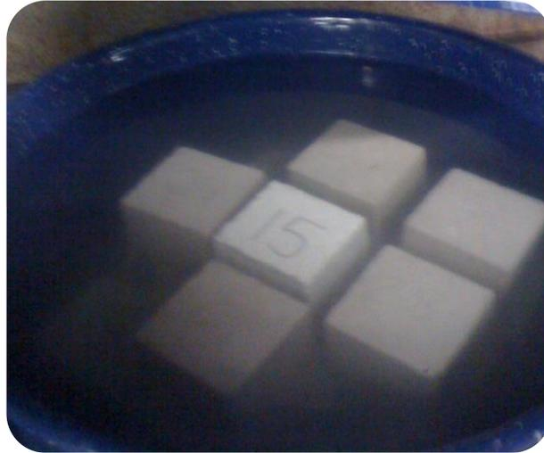
**Figura 8.** Probetas de concreto refractario convencional sumergidas en agua
