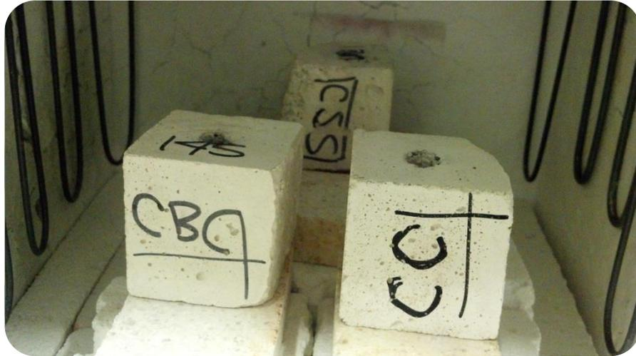
**Figura 11.** Concretos refractarios convencional, bajo y cero cemento, posterior al tratamiento térmico en el horno de resistencias eléctricas.
