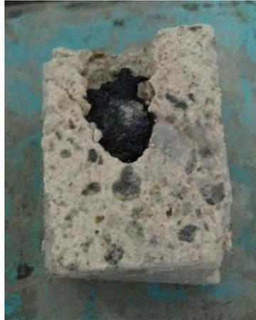
**Figura 38.** Concreto refractario convencional atacado y posteriormente seccionado.
