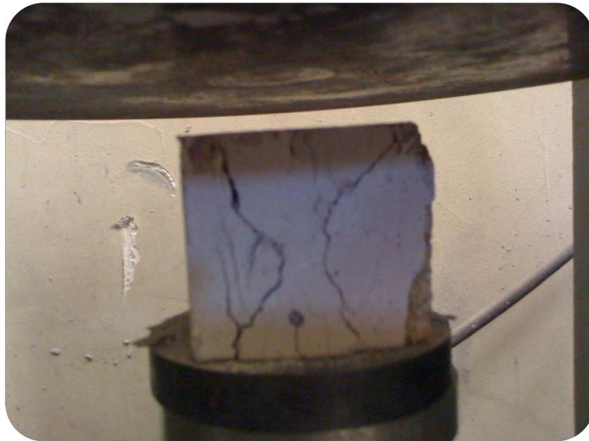
**Figura 9.** Probeta de concreto refractario bajo cemento una vez finalizado el ensayo de resistencia mecánica a la compresión en frío.
