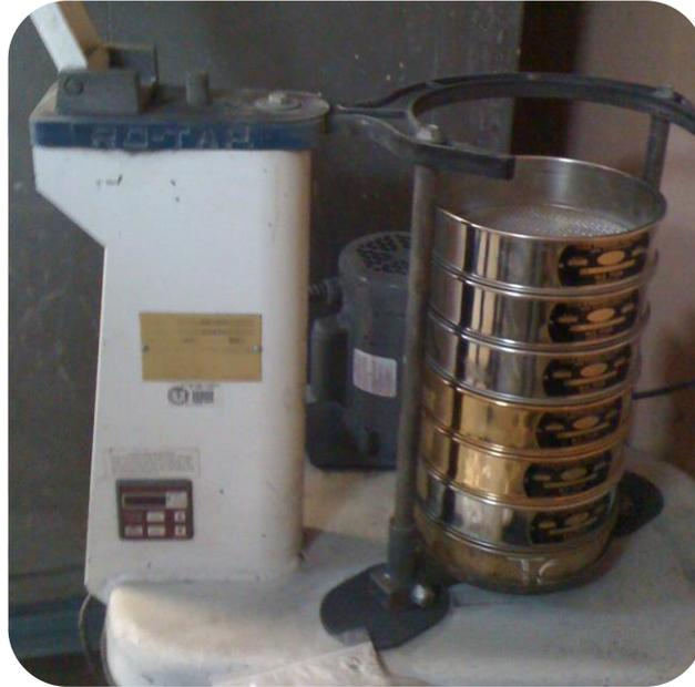
Figura 7. Rot-tap usado en el análisis granulométrico
