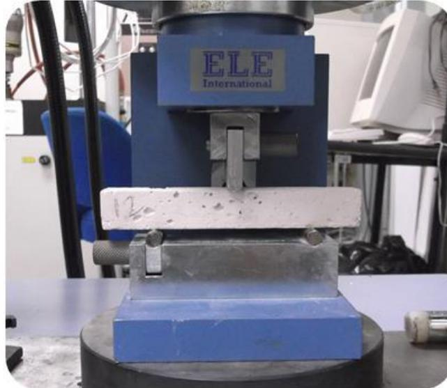
**Figura 10.** Probeta de concreto refractario bajo cemento una vez finalizado el ensayo de flexión
