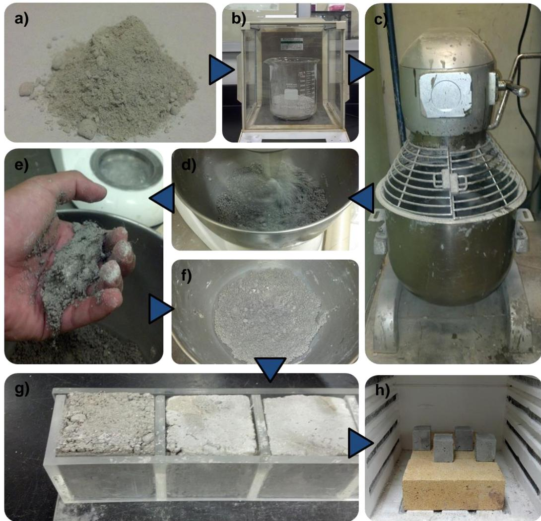
**Figura 3.** Producción de probetas de concreto refractario. a) refractario moldeable, b) pesaje del refractario, c) y d) mezclado del moldeable y el agente fraguante, e) y f) refractario moldeable recién mezclado, g) probetas de concreto refractario pasadas 24 horas de fraguado, h) probetas de concreto refractario después del tratamiento térmico.
