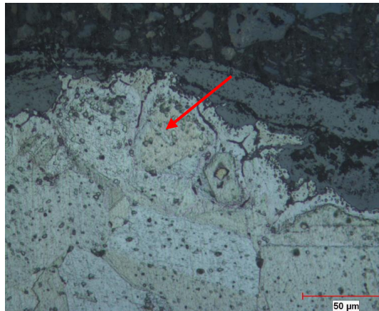
Figura 4.9 Difusión del óxido a través de los límites de grano
