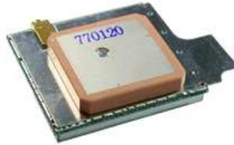
Figura B.5: Módulos de recepción GPS del cuadricóptero experimental.
