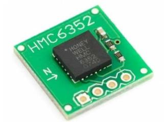
Figura B.4: Brújula electrónica del cuadrirotor experimental.
