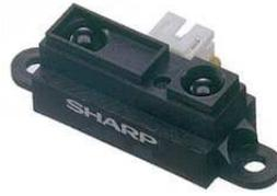
Figura B.6: Sensor infrarrojo de distancia del cuadrirotor experimental.
