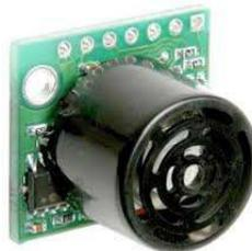
Figura B.7: Sensor ultrasónico de distancia del cuadrirotor experimental.
