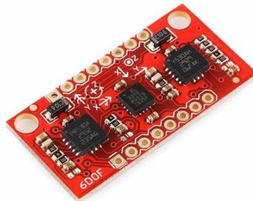
Figura B.3: Unidad de medición de inercia del cuadrirotor experimental.
