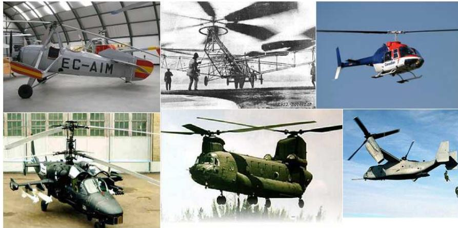
Figura 1.1: Diversas configuraciones de helicópteros de acuerdo al número de hélices.
