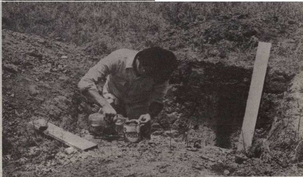
Figura N° 13. Preparación de la solución a base de pegamento de contacto y thinner en el campo.
