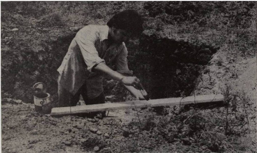
Figura N° 15 . Aplicación de la solución a base de pe-- gamento de contacto sobre la tabla de - montaje.
