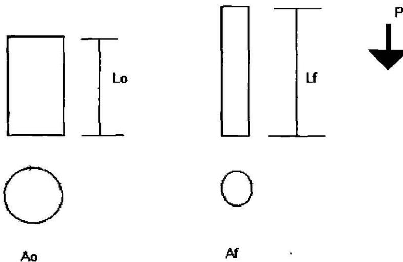
RIGIDEZ ES EL ESFUERZO REQUERIDO PARA PRODUCIR UNA DEFORMACION DADA. SE MIDE A TRAVES DE LA OBTENCION DEL MODULO DE ELASTICIDAD PARA CARGA AXIAL (E) Y REPRESENTA LA TANGENTE DE LA PENDIENTE EN LA GRAFICA ESFUERZO VS. DEFORMACION, ESTE MODULO SE PUEDE OBTENER CONSIDERANDO DOS PUNTOS SOBRE LA PENDIENTE Y REALIZANDO UN TRIANGULO COMO SE MUESTRA EN LA SIG. FIGURA
