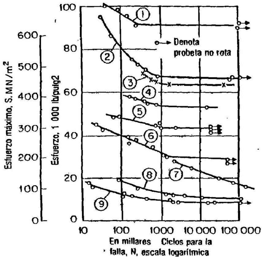
**Fig. 17** Diagramas S-N de ensayos de fatiga: 1) acero de 1.20 C, templado, revenido 733 K (860°F); 2) SAE 3420, templado, revenido 923 K (2 200°F); 3) aleación acero estructural; 4) SAE 1050, templado, revenido 1 200°F; 5) SAE 4130, normalizado, recocido; 6) acero estructural ordinario; 7) Duraluminio; 8) cobre recocido; 9) fundición de hierro. (Flexión opuesta.)
