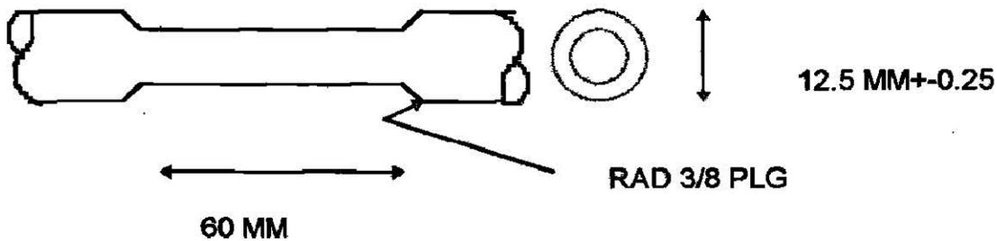
PROBETA DE ENSAYO, LONGITUD DE MEDICION 50MM
