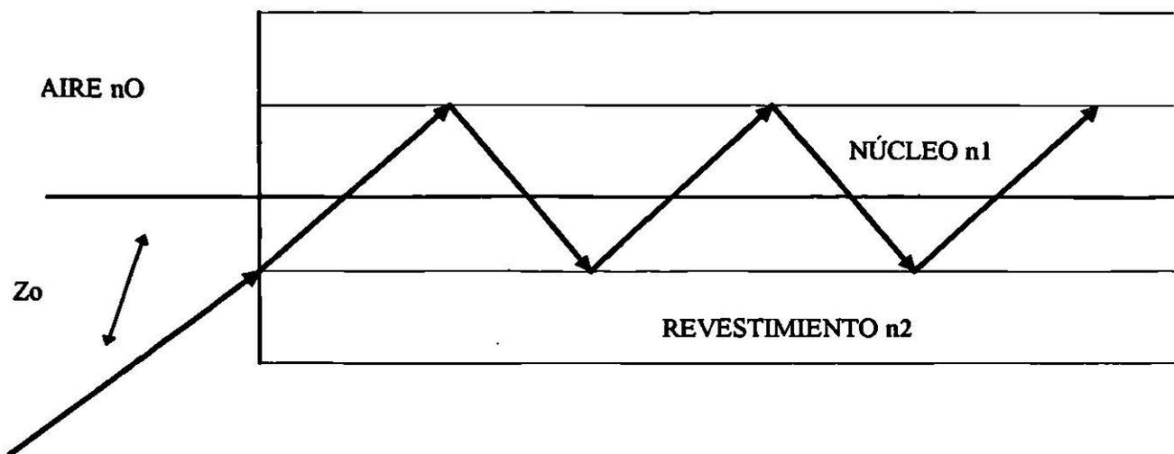
Angulo  $Z_0$  que forma luz y el eje de la fibra óptica
