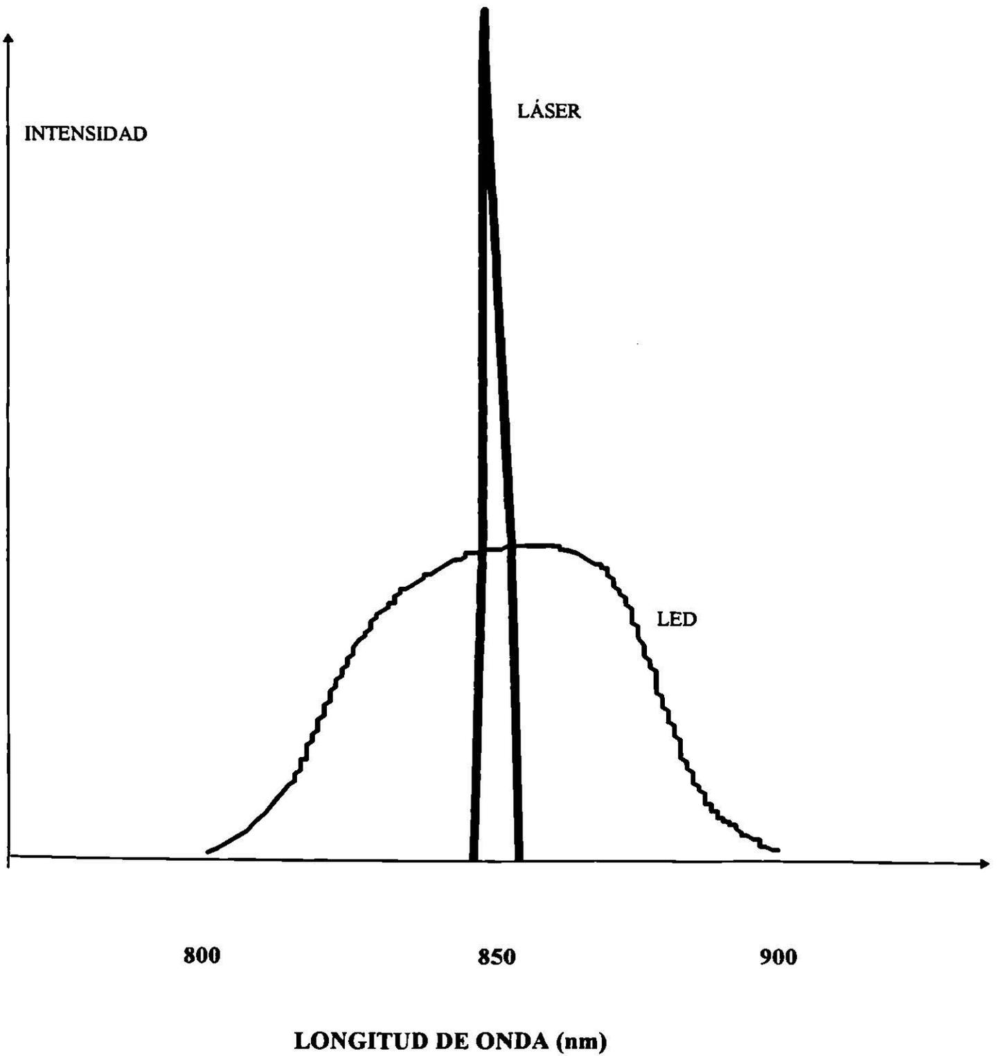
**PERFIL ESPECTRAL COMPARATIVO DE UN LÁSER Y UN LED**
