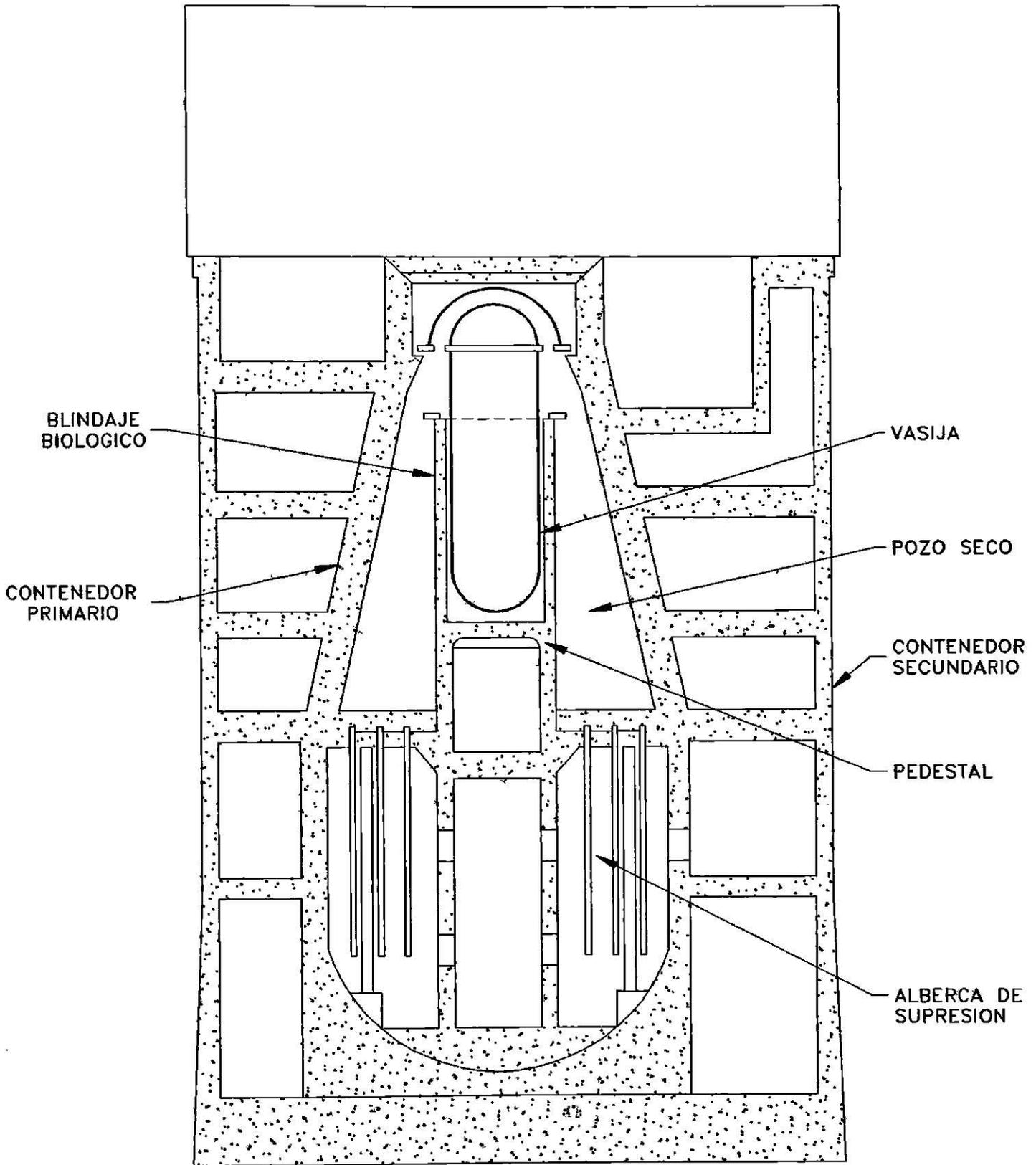
SISTEMA DE CONTENCION DE UN REACTOR BWR
