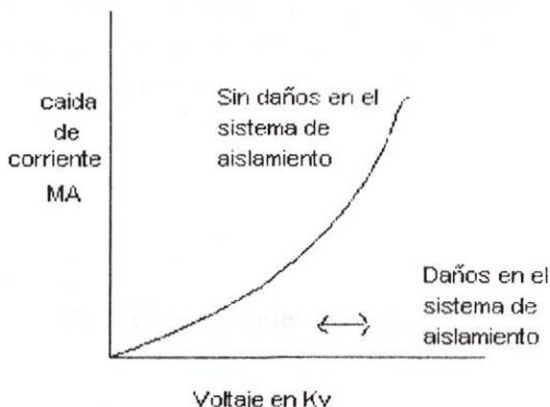
Fig. 2.6 Paso de voltaje alto - potencial prueba de corriente .
