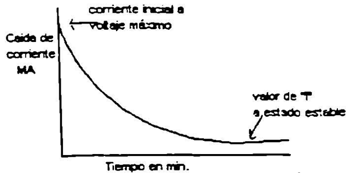
fig. 2.6 Caída de corriente contra tiempo
