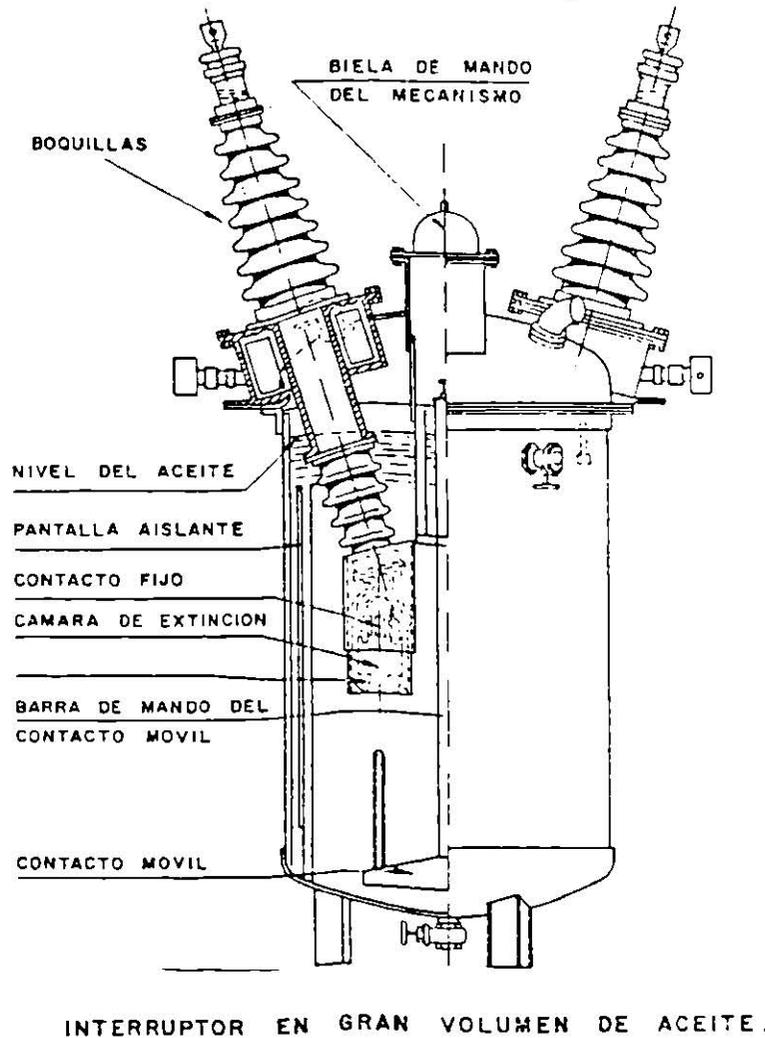
Cuando opera el interruptor figura 1.4 debido a una falla, los contactos móviles se desplazan hacia abajo, separándose de los contactos fijos. Al alejarse los contactos móviles de los fijos se va creando una cierta distancia entre ellos, y en función de esta distancia está la longitud del arco. El arco da lugar a la formación de gases, de tal manera que se crea una burbuja de gas alrededor de los contactos que desplaza una determinada cantidad de aceite.
