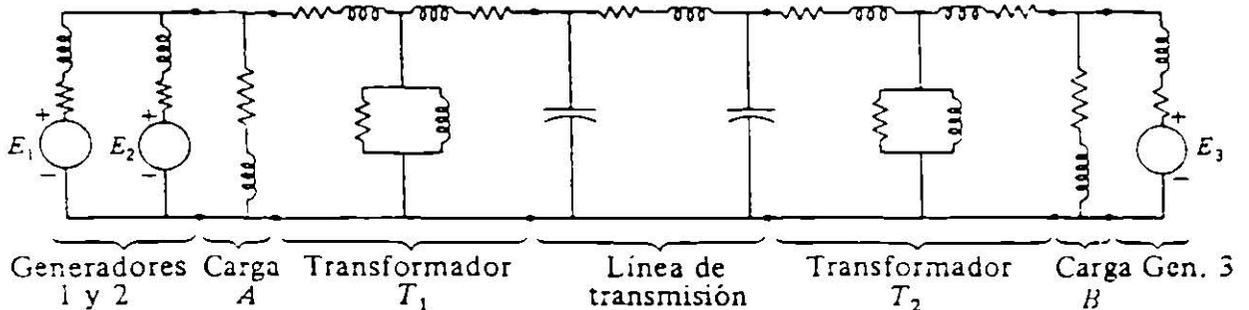
El diagrama de impedancias no incluye las impedancias limitadoras de corriente, que se ven en el unifilar entre los neutros de los generadores y tierra, porque en condiciones de equilibrio, no circulan corrientes por la tierra y neutros de los generadores están al mismo potencial que el neutro del sistema.
