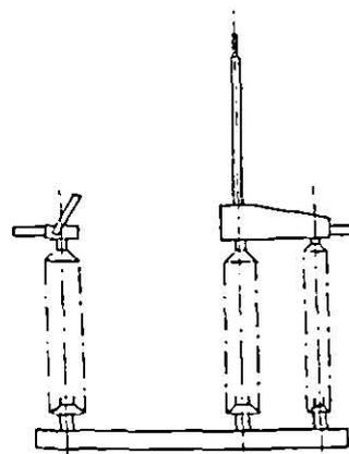
CUCHILLA DESCONECTADORA DE TRES COLUMNAS
