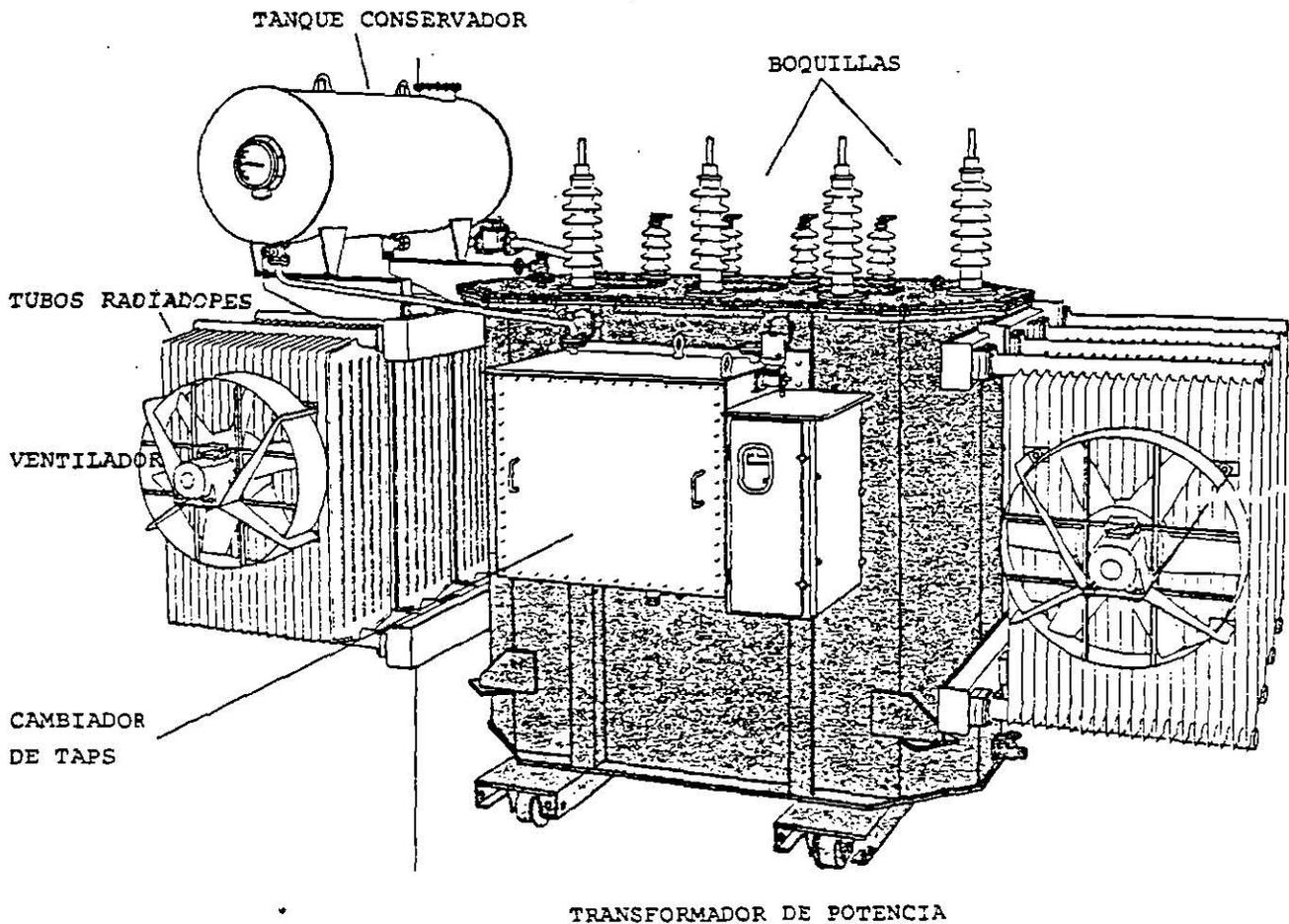
La capacidad de sobrecarga de un transformador, es funcion de su capacidad de disipacion de calor, o sea que en cualquier situacion de operacion, un transformador se puede sobrecargar sobre su capacidad nominal por un cierto periodo de tiempo. Por ejemplo, para transformadores de distribucion sumergidos en aceite, la norma ANSI C57.96, da los siguientes valores:
