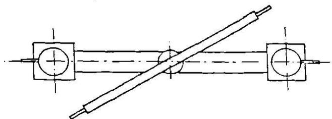
CUCHILLA DESCONECTADORA DE TRES COLUMNAS
