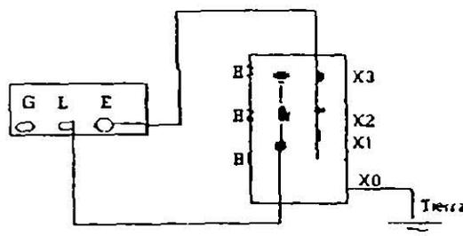
Fig. 2.2 Conexiones de prueba para resistencia de aislamiento para transformadores trifásicos. (a) Conexión de bobina de alta a bobina de baja a tierra; (b) Conexión para bobina de alta a tierra y bobina de alta protegida; (c) Conexión de bobina de baja a bobina de alta a tierra. (d) Conexión de bobina de baja a tierra y bobina de alta y protegida; (e) Conexión de bobina de alta a bobina de baja.
