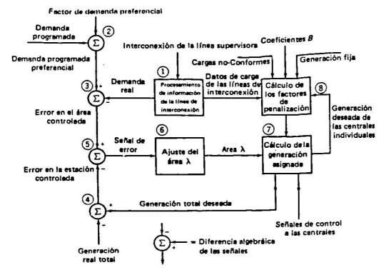
Fig. 1.1 Diagrama en bloques
