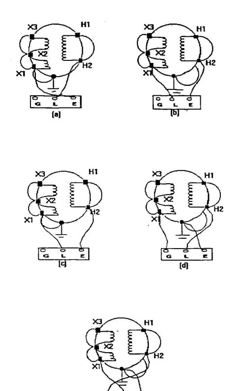
Fig. 2.1 Prueba de conexiones para aislamiento resistivo de transformadores de una sola fase
