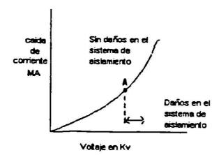
Fig. 2.5 Paso de votaje alto - potencial prueba de corriente .
