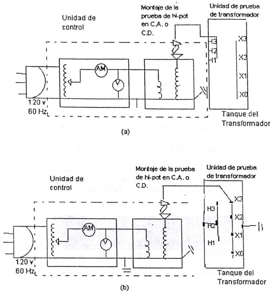
Fig. 2.3 Conexión de la prueba de alto voltaje del transformador (HI - POT). (a) Conexión de la prueba HI - POT en las bobinas de alta. (b) Conexión de la alta de la prueba de HI - POT en las bobinas de baja.
