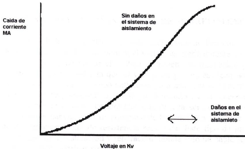
Fig. 2.6 Paso de voltaje alto – potencial prueba de corriente
