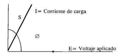
El aislamiento del factor de potencia es una herramienta importante para determinar la calidad del aislamiento para transformadores, interruptores, máquinas giratorias, cables, reguladores y líquidos aislantes. Varias precauciones deberán tomarse en cuenta cuando se hace tina prueba de factor de potencia.
