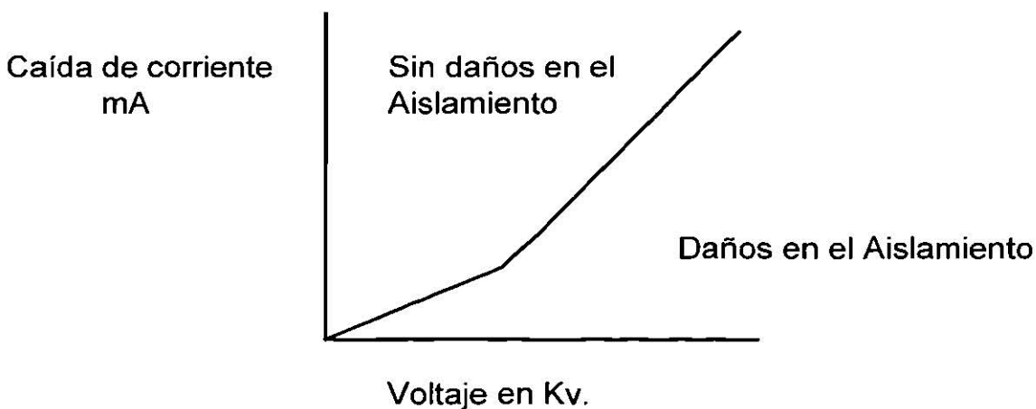
Figura 2.6 Paso de voltaje alto-potencial prueba de corriente
