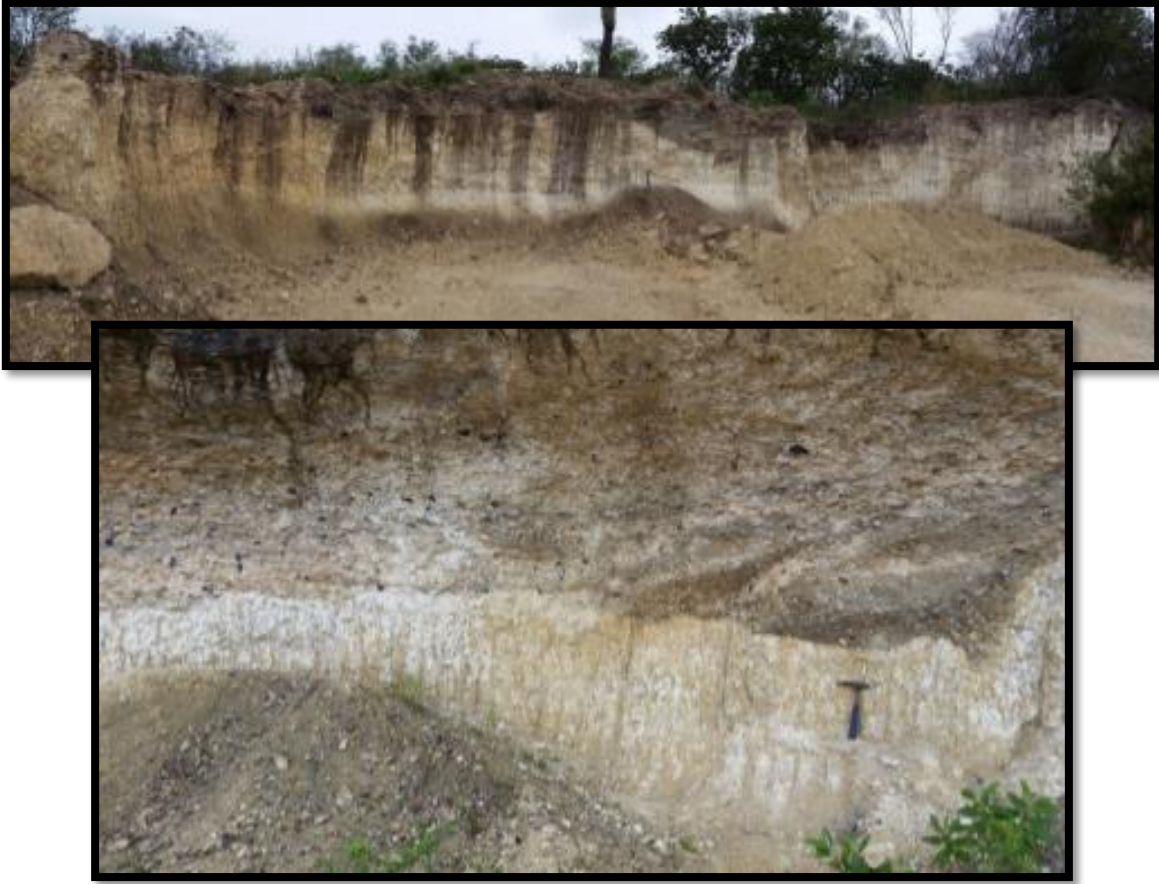
Figura 7 Recorte transversal de la loma, en la imagen se puede observar los dos tipos de texturas que muestra el caliche. Las manchas de escorrentías de agua se hacen presentes en color negro a gris oscuro, ocasionadas por el agua producto de la vegetación del lugar. Estas manchas son similares a las que se presentan en las rocas que conforman el Templo. Zona ubicada en la colonia “La Loma” al sur de la ciudad de Linares.
